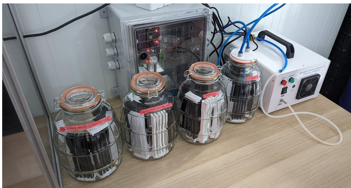
Rys. 17. Stanowisko eksperymentalne do symulacji wpływu metod dezynfekcji na próbki wykonane z tworzyw sztucznych
