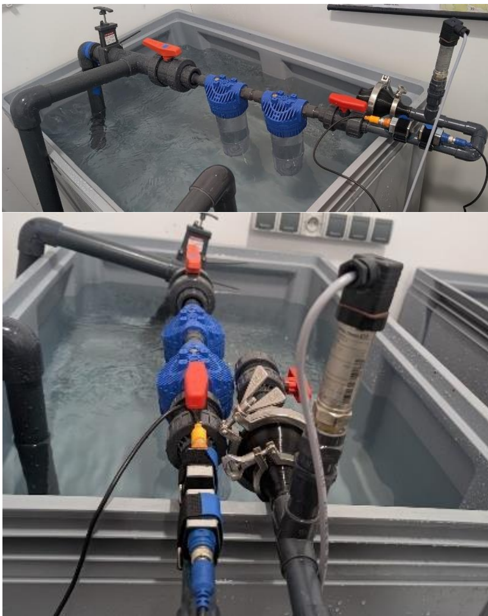
Rys. 81. Układ zmodyfikowany poprzez dodanie czujnika ciśnienia dla powtórzeń nr 2 oraz nr 3 eksperymentu z wykorzystaniem finalnego prototypu zażęzania próbek biologicznych
