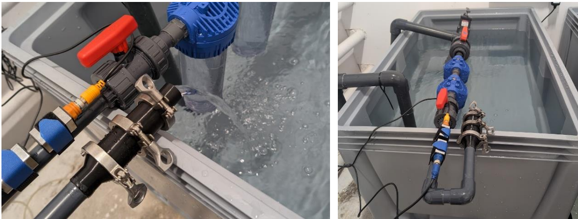
Rys. 71. Fotografie prezentujące uproszczony układ do pobierania próbek biologicznych podczas pracy
