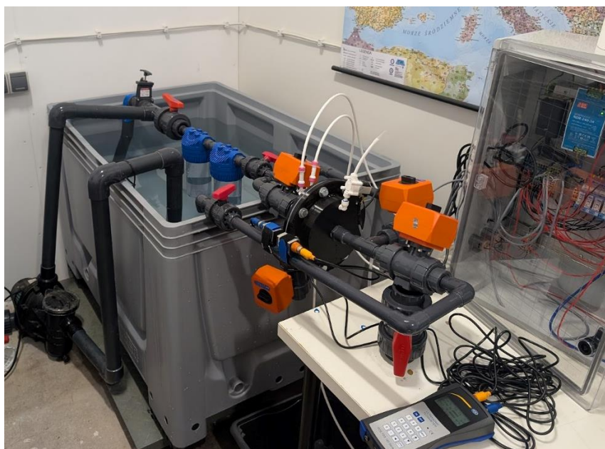
Rys. 45. Gotowe stanowisko do walidacji układu pobierania próbek wody
