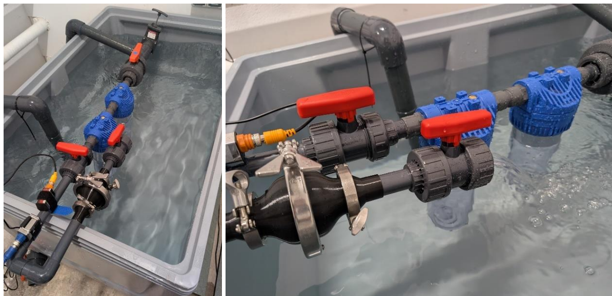
Rys. 78. Układ finalnego prototypu układu zatężania próbek biologicznych podczas pracy
