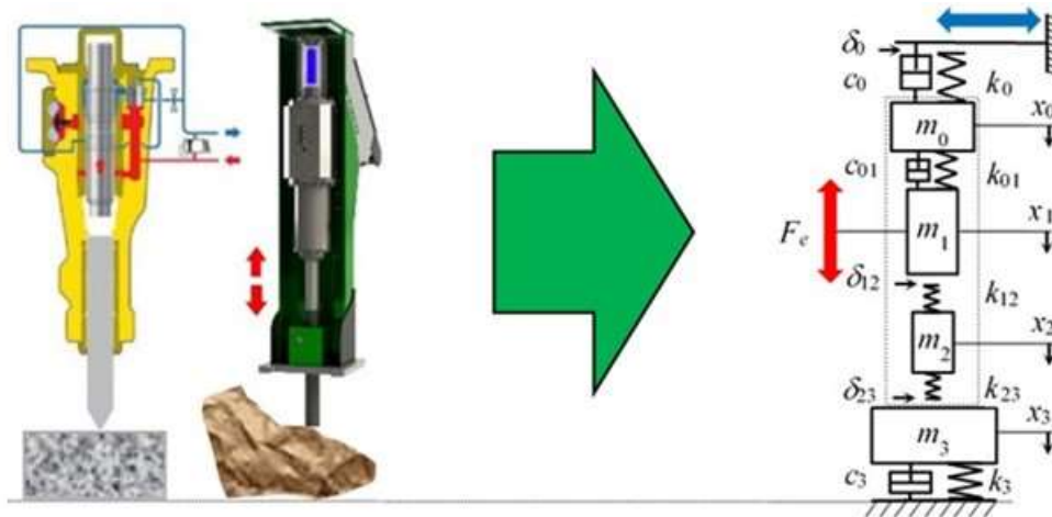
Rys. 25. Model dynamiczny młota kruszącego uwzględniający manipulator i kruszony materiał
