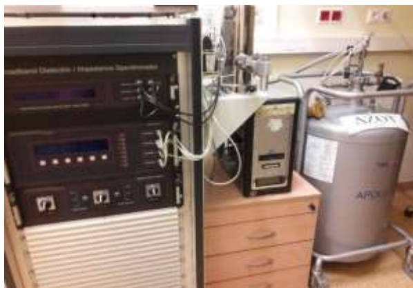
Rys. 5.2 Elementy układu pomiarowego do badań dielektrycznych.
