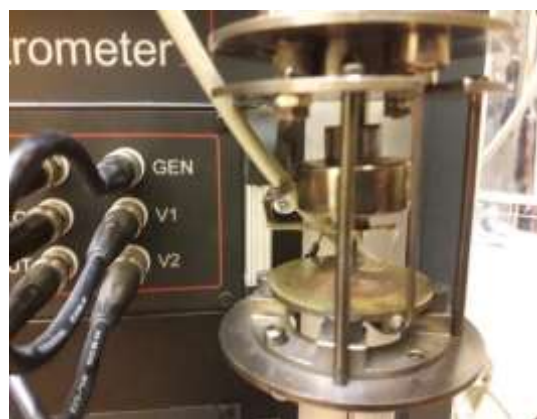
Rys. 5.2 Elementy układu pomiarowego do badań dielektrycznych.
