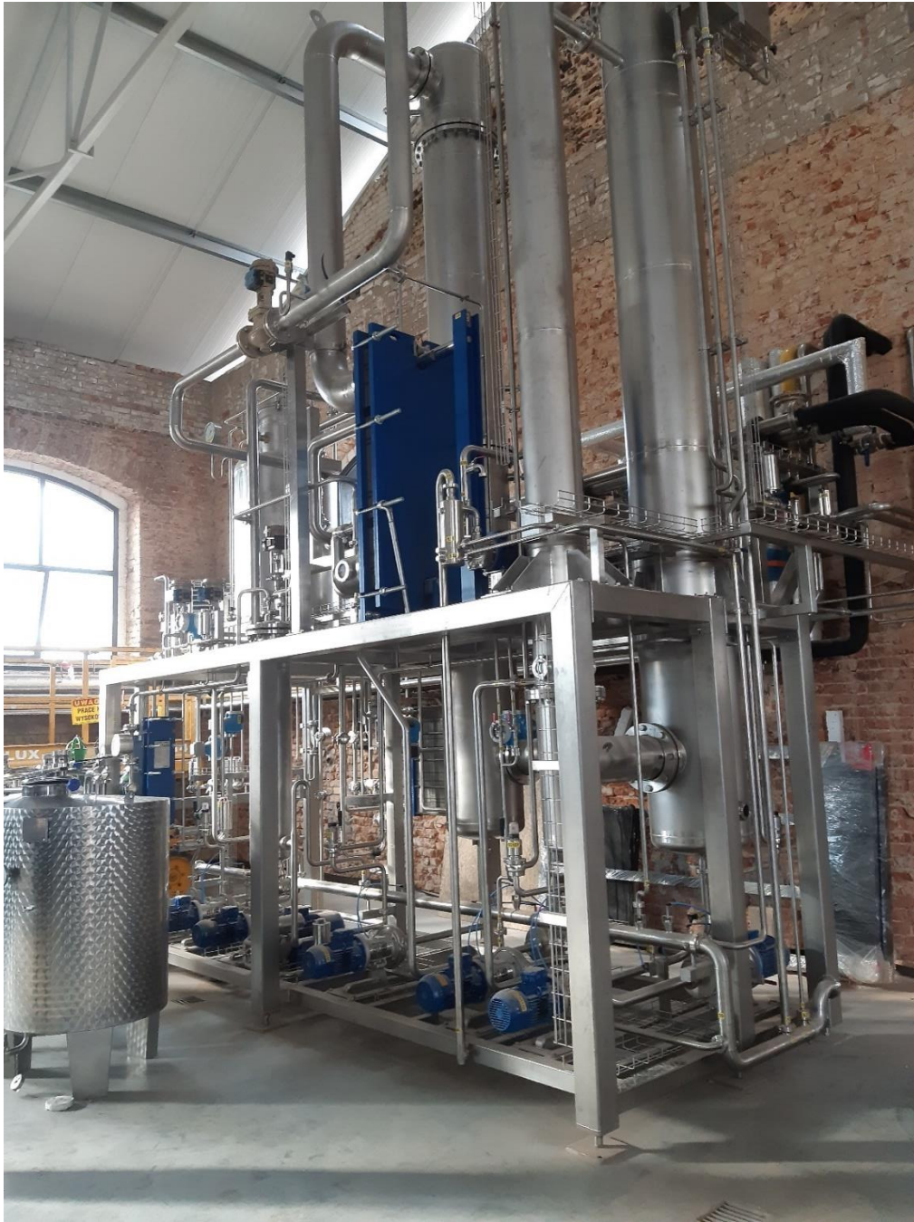
Rysunek 23. Aparatura do rektyfikacji próżniowej firmy Schmidt znajdująca się w browarze Tenczynek
