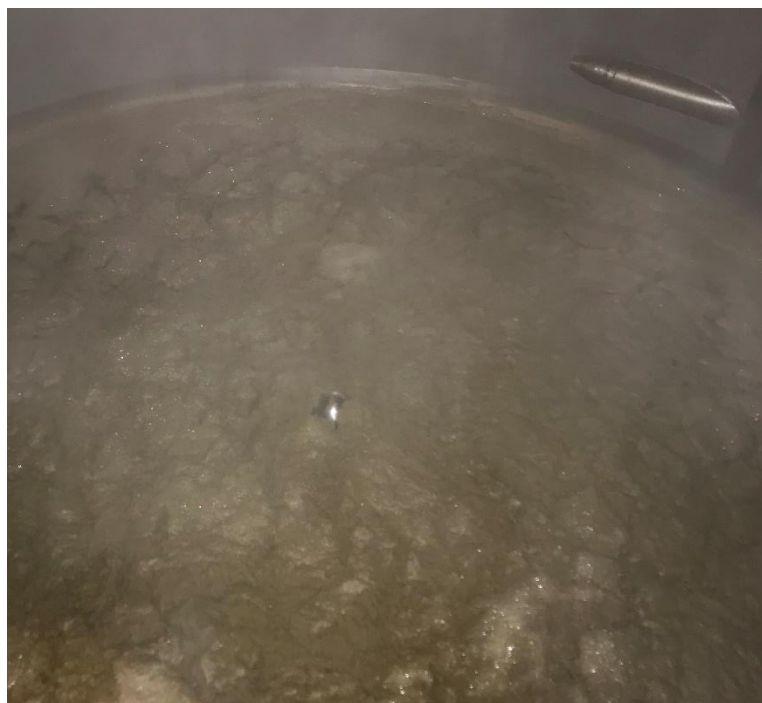
Rysunek 17. Osady powstałe po odwirowaniu gorącej brzezki w Browarze Jastrzębie. Fot. Mateusz Błatoń
