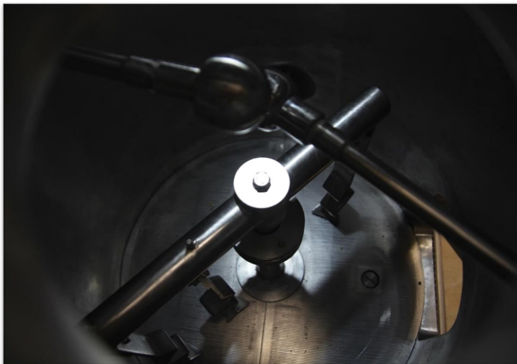
Rysunek 14. Wnętrze kadzi filtracyjnej. Na ilustracji widać fałszywe dno, mieszalnik mechaniczny jak i zraszacz używane do wypłukiwania pozostałych cukrów z młota
