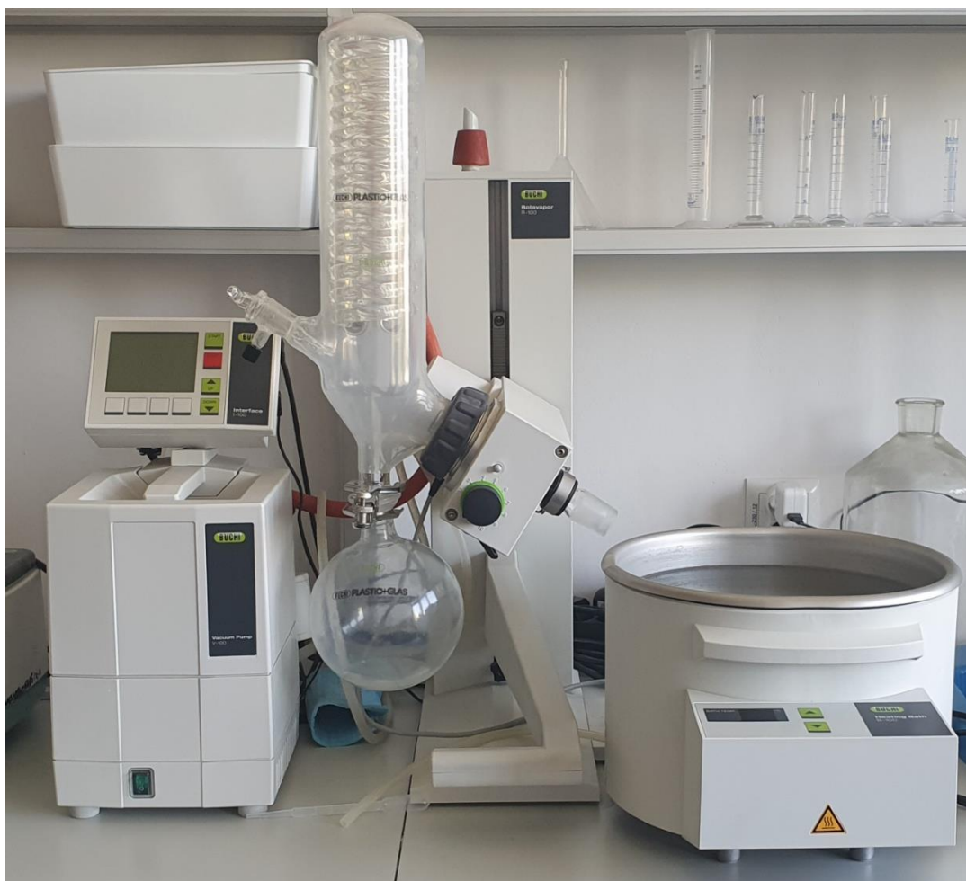
Rysunek 34. Zestaw do destylacji próżniowej firmy Büchi
