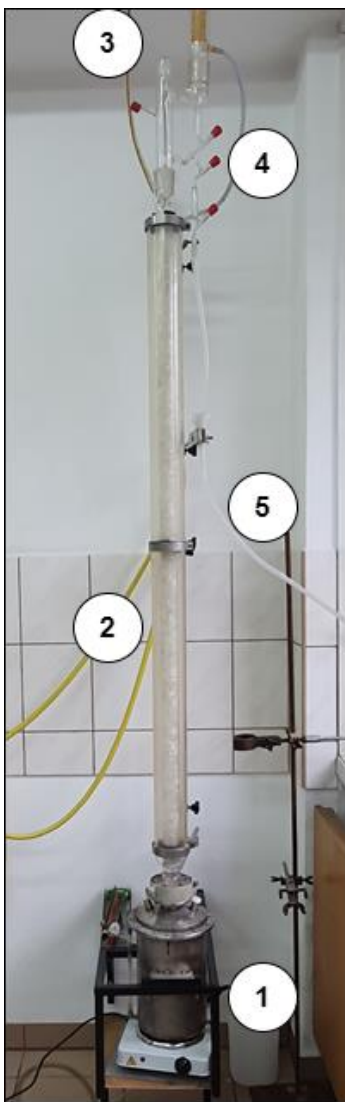
Rysunek 33. Kolumna do destylacji z deflegmacją. 1 - zbiornik nadawy z płaszczem grzewczym, 2 - kolumna z wypełnieniem, 3- chłodnica, 4 - komora zaworowa, 5 - wężyk odprowadzający destylat
