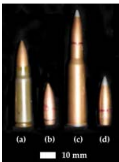
Rys. 32. Obrazy makroskopowe amunicji wykorzystanej do testów balistycznych: a-b) nabój i pocisk 7,62 × 39 mm nb. wz. 43 z poc. PS, c-d) nabój i pocisk 7,62 × 54R mm nb. kb. ŁPS.
