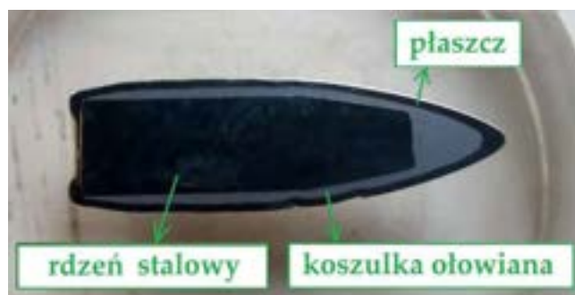
Rys. 211. Przekrój podłużny pocisku 7,62 × 39 mm nb. wz. 43 z poc. PS.
