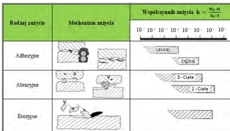
Rys. 3. Wartości współczynnika zużywania k w funkcji rodzaju zużywania w warunkach tarcia suchego [7].
