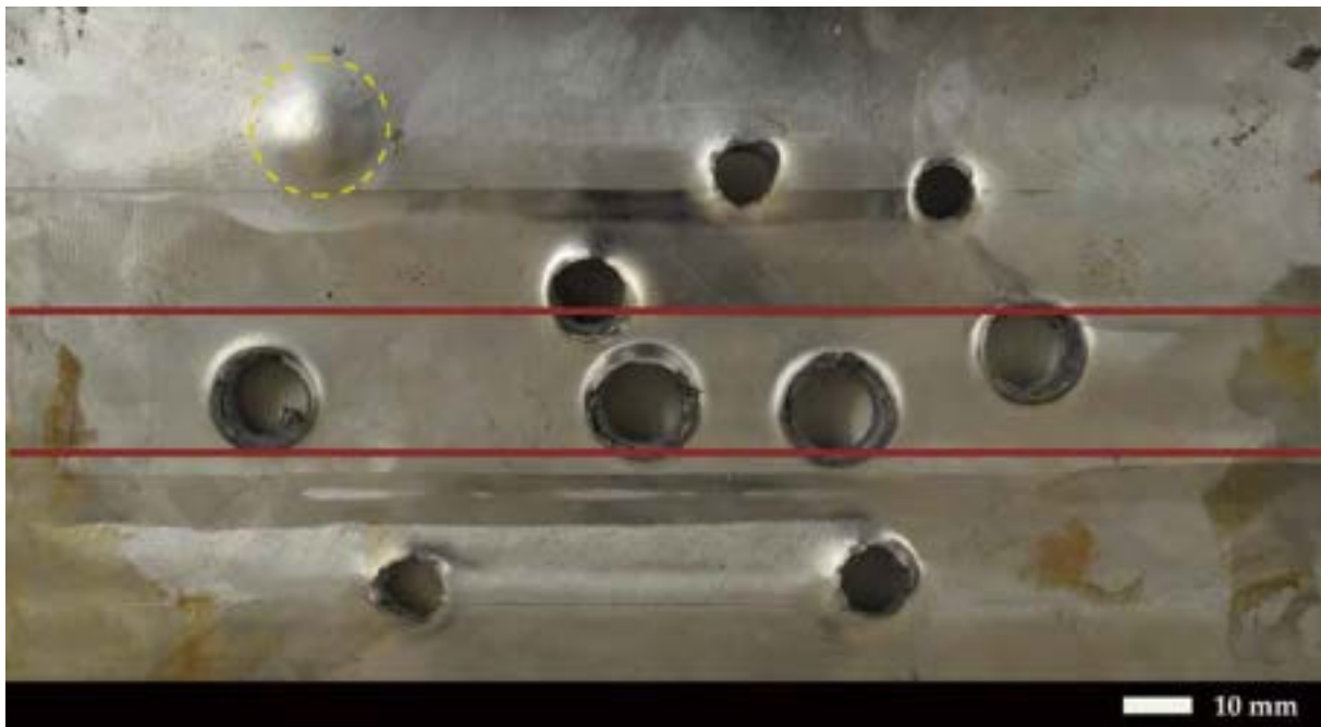
Rys. 293. Obraz makroskopowy powierzchni ostrzelanej blachy złącza spawanego stali Hardox 450 o grubości 8 mm w stanie bezpośrednio po spawaniu. Strona tylna. W strefie materiału spoiny charakterystyczne wygięcie w tył, w strefie wpływu ciepła obserwuje się nieznaczną deformację plastyczną. Widoczne wybrzuszenie oznaczone przerywanym okręgiem w strefie materiału rodzimego. Czerwone linie ograniczają w przybliżeniu obszar złącza spawanego.
