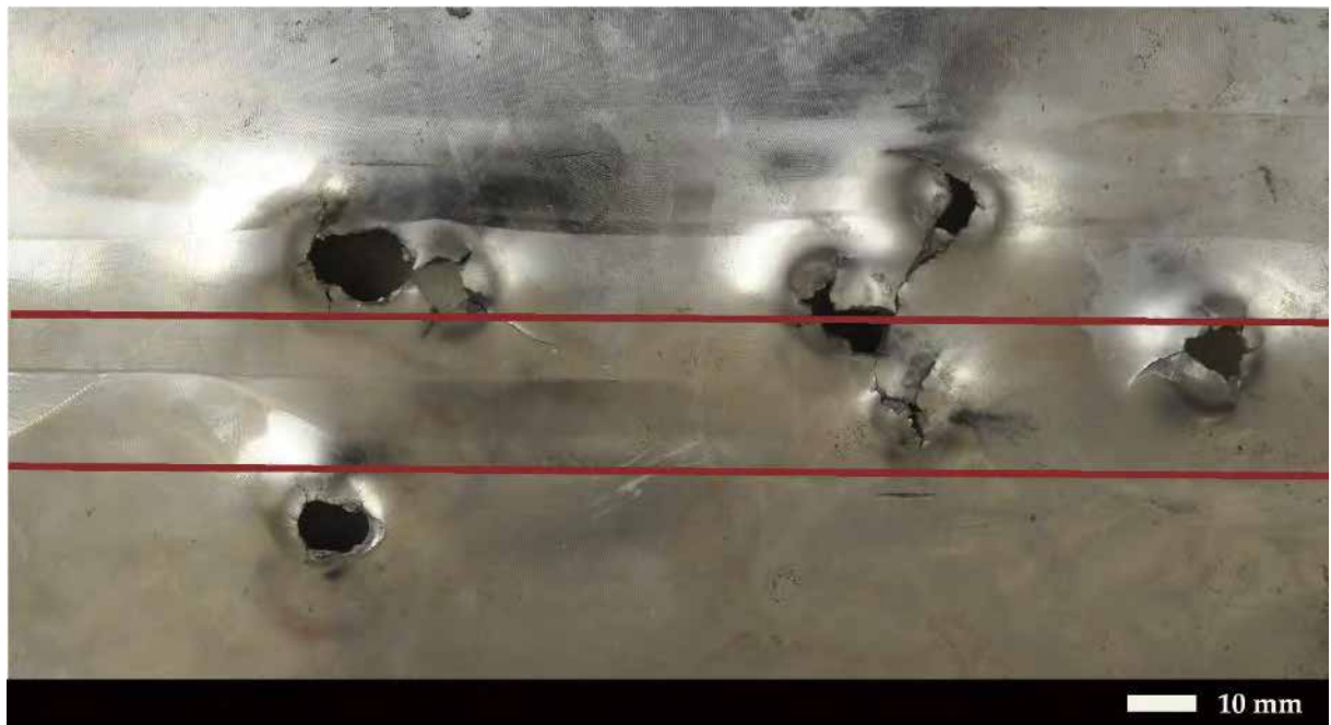
Rys. 237. Obraz makroskopowy powierzchni blachy złącza spawanego stali Hardox 450 o grubości 4 mm w stanie obrobionym cieplnie po uderzeniach balistycznych. Strona tylna. Widoczne wygięcia i promieniujące pęknięcia. Czerwone linie ograniczają w przybliżeniu obszar złącza spawanego.
