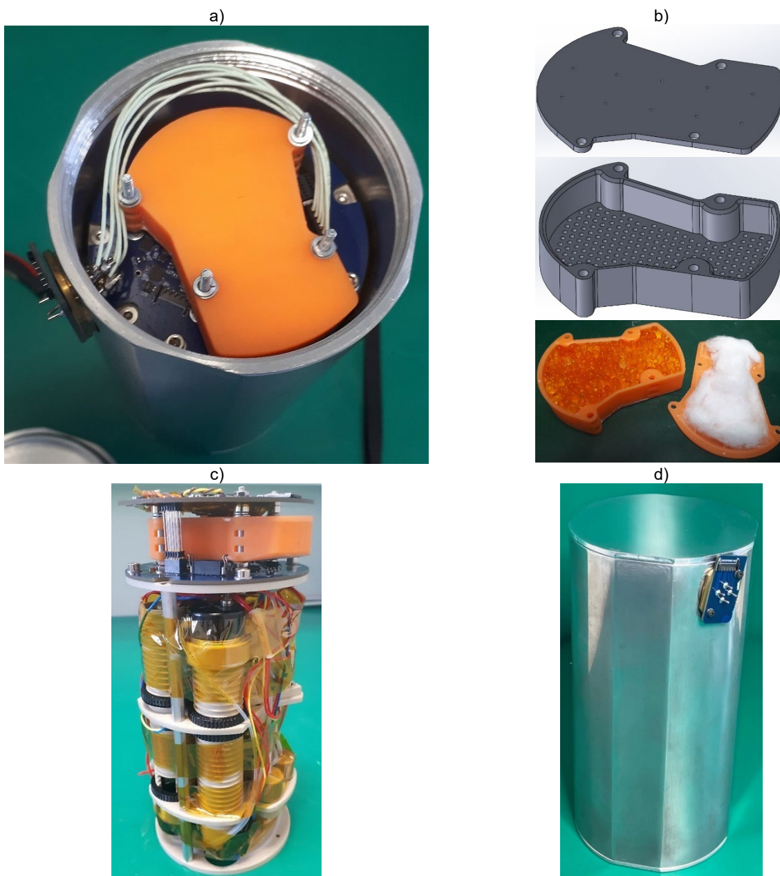
Rys. 87 Sekcja PS i lab-insert w obudowie: a) krok pośredni montażu sekcji PS – przykręcony układ PS1 i podłączone do niego przewody z przepustu oraz zamocowany pochłaniacz wilgoci; b) pochłaniacz wilgoci – model oraz realizacja, czyli pojemnik z otworami wypełniony granulatem krzemionkowym i watą higieniczną; c) widok złożenia lab-insertu, w tym sekcji PS poza obudową – montaż próbny; d) FM lab - payloadu – lab-insert hermeticznie zamknięty w termosie.
