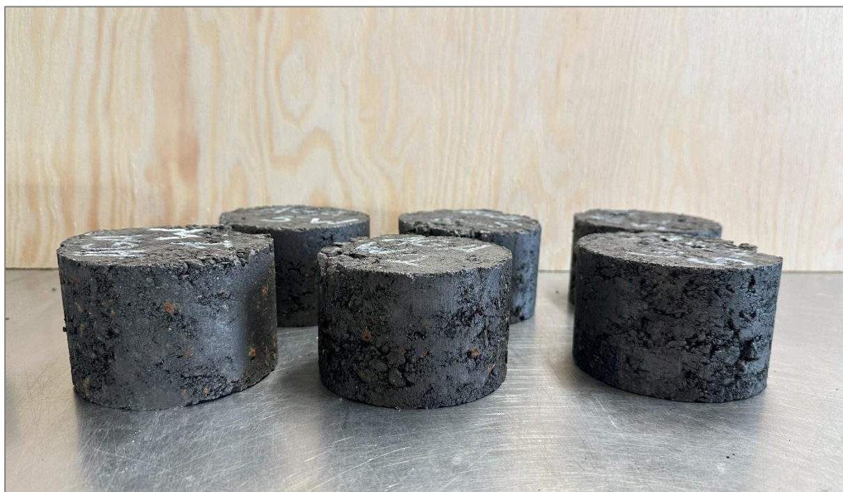
Rys. 65 Próbki AC 11 S PMB 45/80-65 KR3-KR6 z grafitem jako wypełniaczem
