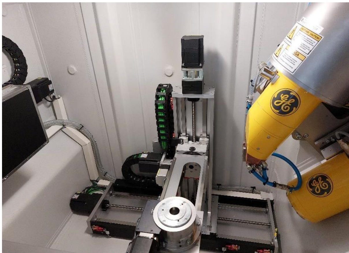
Rys. 57 Wnętrze Mikrotomografu rentgenowskiego phoenix v|tome|x s
