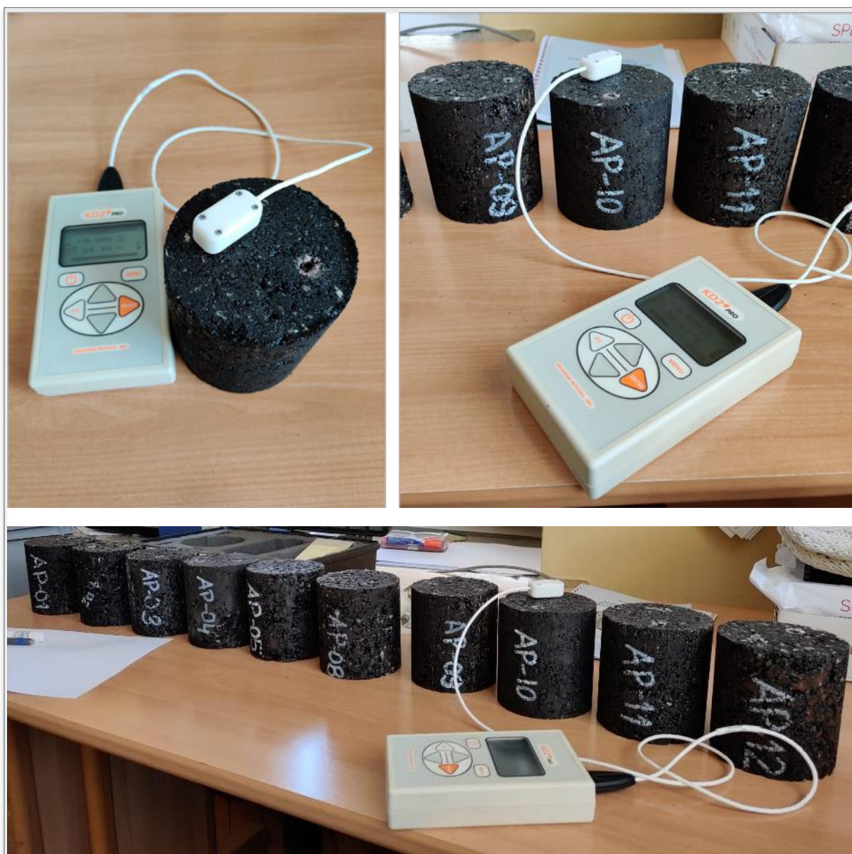
Rys. 52 Pomiar przewodności cieplnej próbek mieszanki mineralno-asfaltowej za pomocą miernika KD2 Pro Thermal Analyzer
