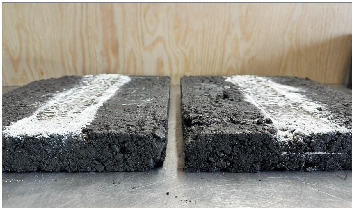
Rys. 66 Próbki mieszanki AC 11 S PMB 45/80-65 KR3-KR6 z grafitem po badaniu kolejowania
