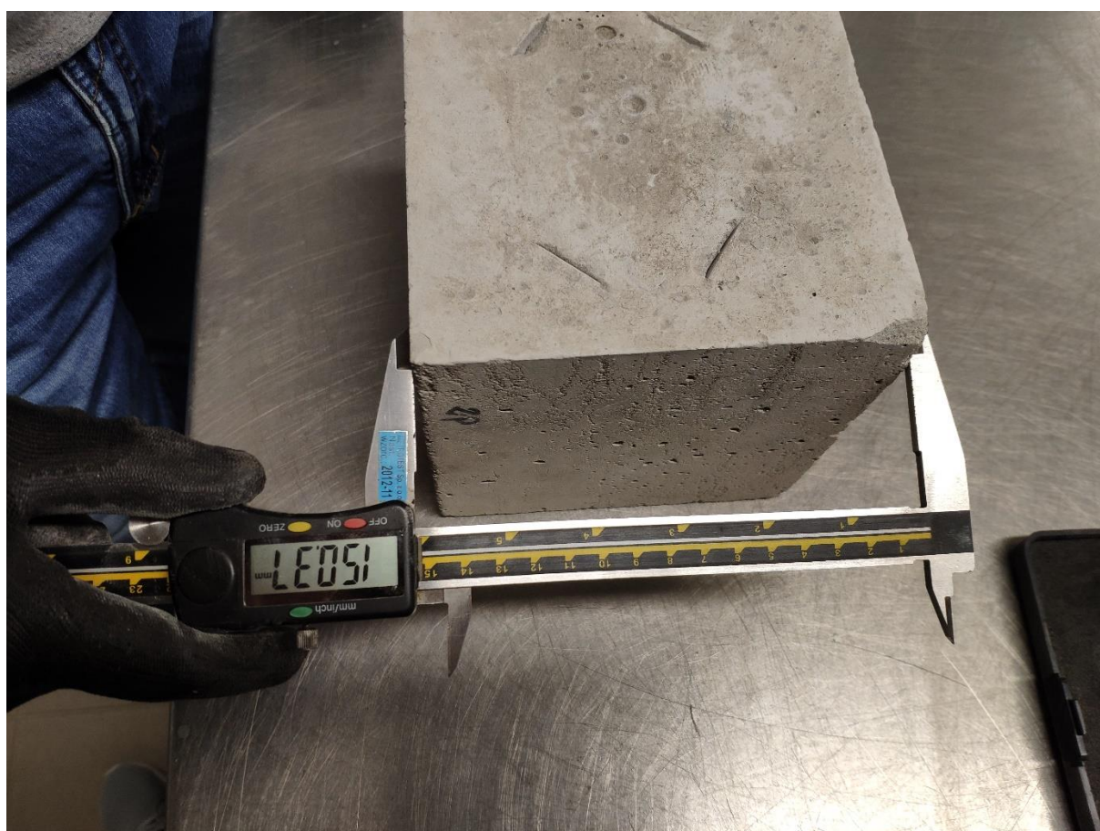
Rys. 36. Sprawdzenie wymiarów próbki za pomocą suwmiarki elektronicznej firmy VOREL
