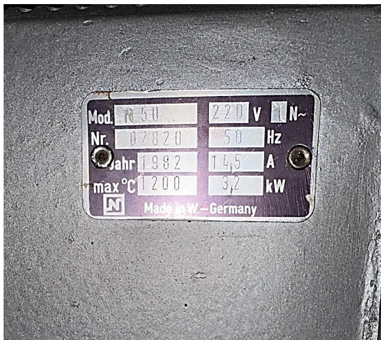
Rys. 28. Naber 50 – tabliczka znamionowa
