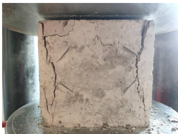
Rys. 39. Typ zniszczenia – próbka 1A
