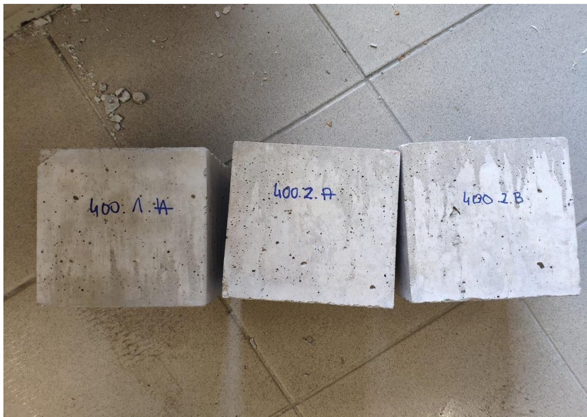
Rys. 42. Próbkki 400.1.A, 400.2.A i 400.2.B przed wygrzewaniem
