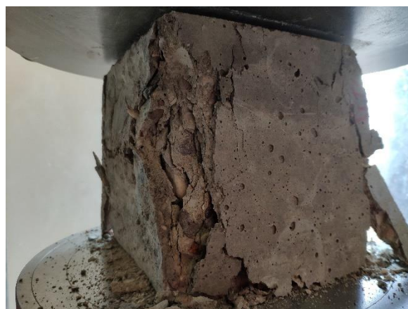
Rys. 47. Wygrzana próbka 400.0.A po zniszczeniu
