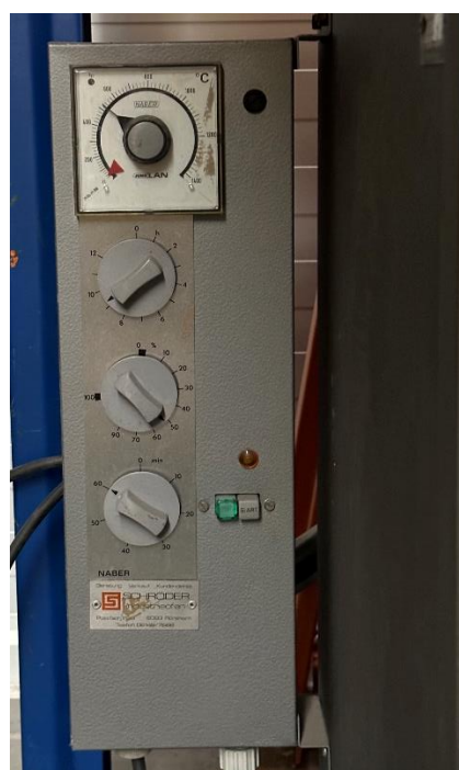
Rys. 27. Naber 50 – panel kontrolny
