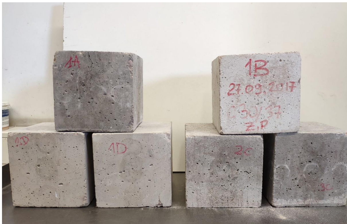
Rys. 35. Próbki po wygrzaniu
