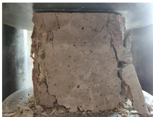
Rys. 40. Typ zniszczenia – próbka 1D
