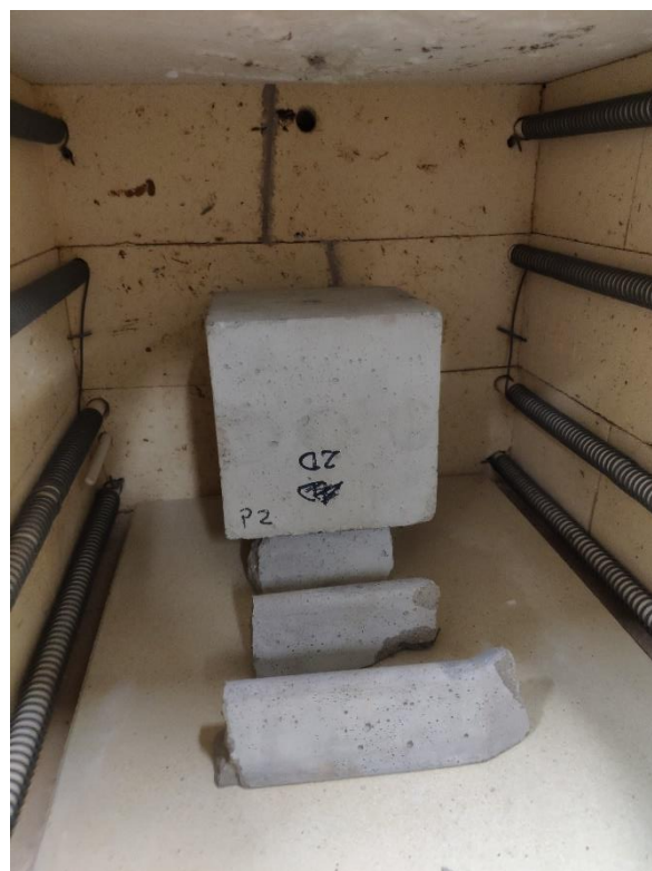
Rys. 31. Próbką i dystanse w piecu
