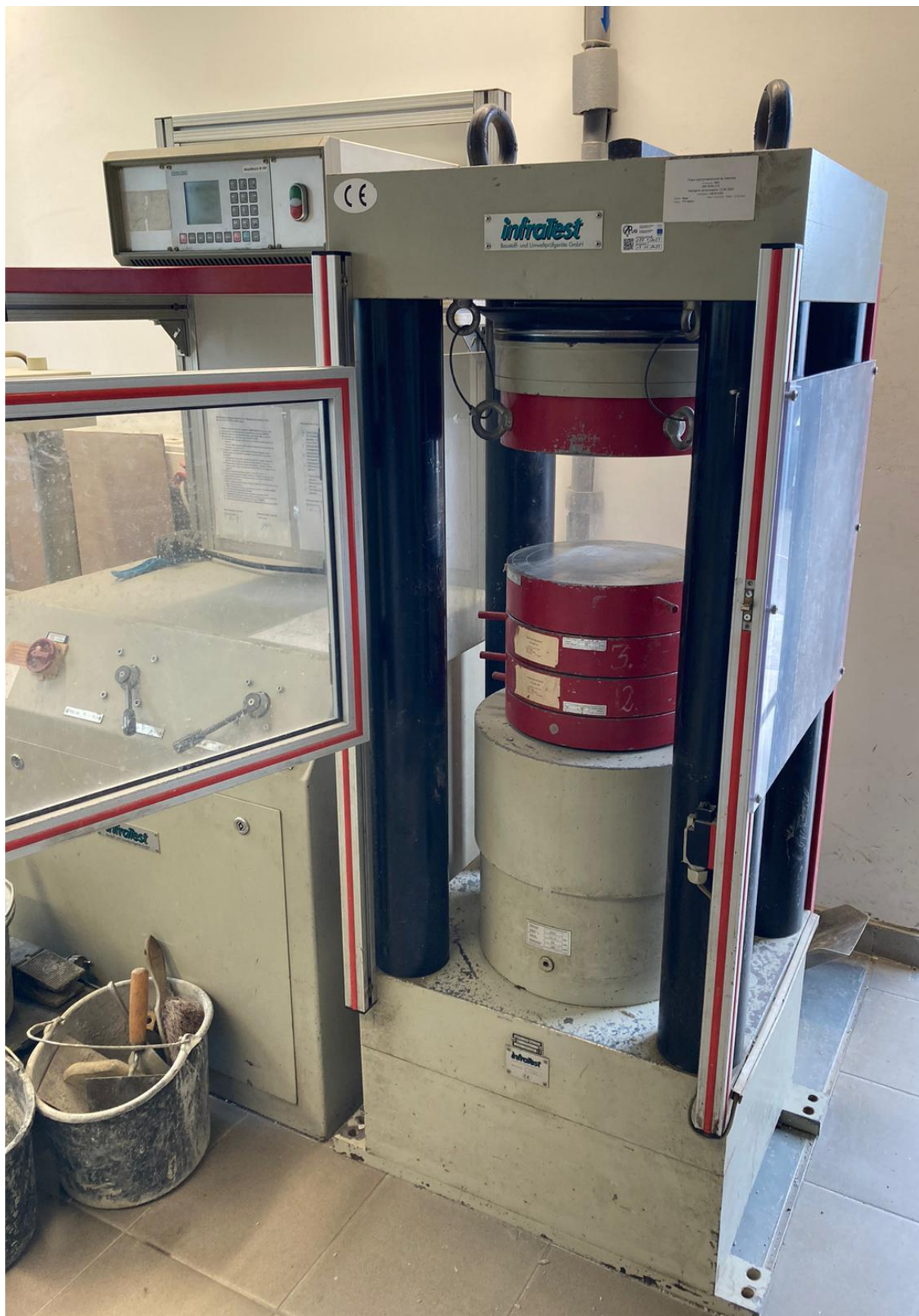
Rys. 37. Maszyna wytrzymałościowa infraTest ALPHA 2-3000 użyta w badaniach
