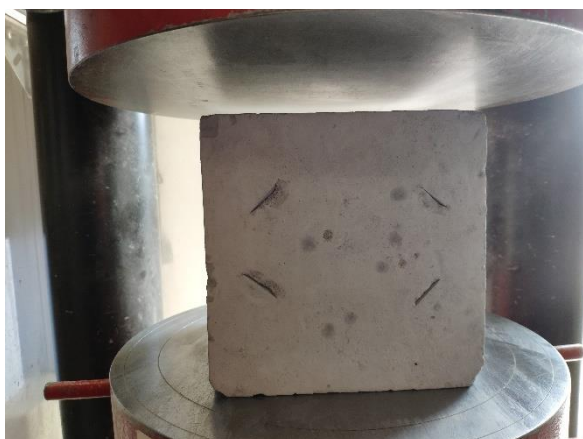
Rys. 46. Wygrzana próbka 400.0.A przed zniszczeniem
