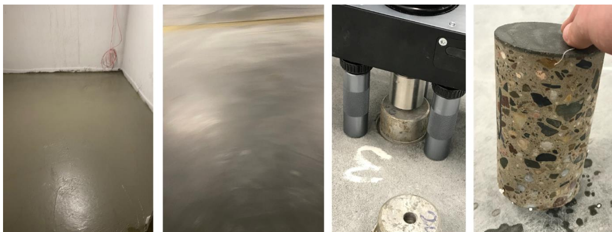
Rysunek 101. Zdjęcia z wykonania oraz badań modyfikowanej cementowej warstwy wierzchniej w praktyce (fotografie własne autora)
