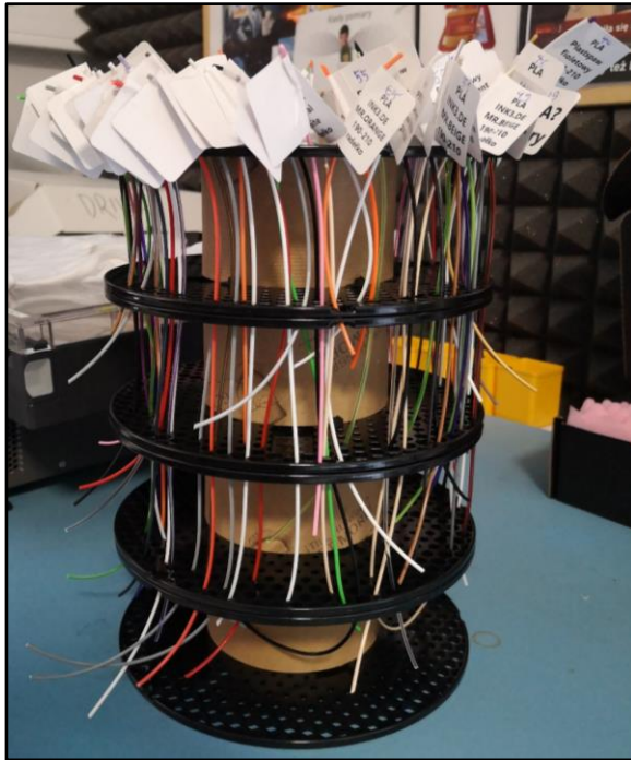
Rysunek 5.2. a) Zbiór ponad setki próbek filamentów od różnych producentów, różnych typów, kolorów i serii o długości nieprzekraczającej 200mm wykorzystanych przy wykonywaniu pomiarów prototypem układu pomiarowego. b) Zbiór 35 próbek filamentów od różnych producentów, różnych typów, kolorów i serii o długości co najmniej 5m wykorzystanych przy wykonywaniu pomiarów finalną wersją układu pomiarowego.
