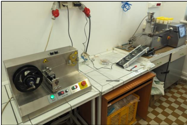
Rysunek 6.4. a) Młyn granulatu Cutting Mill SM 300. b) Suszarka próżniowa Thermo Scientific™ Vacutherm. c) Współbieżna wylączarka dwuślimakowa Thermo Scientific Process 11 podczas ekstruzji. d) Wylączarka jednoślimakowa 3devo Filament Maker Composer podczas ekstruzji.
