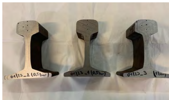
Rysunek 10.22. Przykładowe próbki przygotowane do badań na laboratoryjnym stanowisku do obróbki cieplnej
