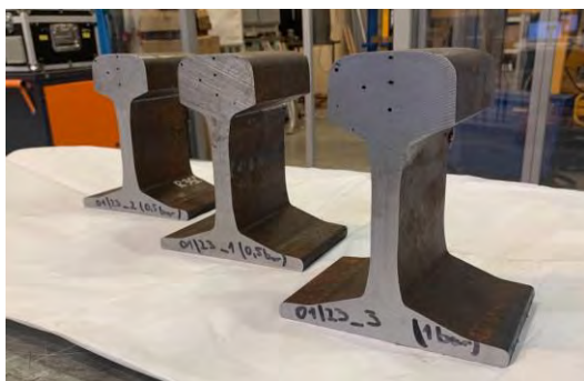
Rysunek 10.22. Przykładowe próbki przygotowane do badań na laboratoryjnym stanowisku do obróbki cieplnej
