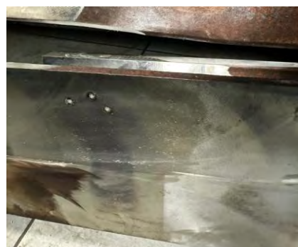
Rysunek 6.1. Pomiar składu spektrometrem a) lokalizacja badań miejsca pomiaru dla próbek a) przed OC b) po OC
