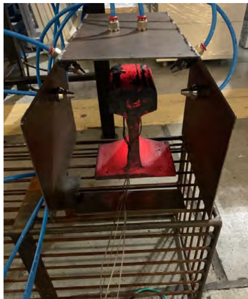
Rysunek 10.23. Stanowisko i próbka a) przed rozpoczęciem fazy kontrolowanego chłodzenia b) w fazie kontrolowanego chłodzenia
