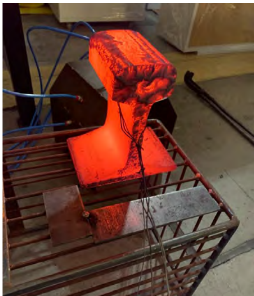
Rysunek 10.23. Stanowisko i próbka a) przed rozpoczęciem fazy kontrolowanego chłodzenia b) w fazie kontrolowanego chłodzenia
