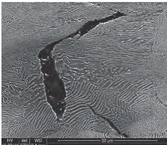
Rysunek 2.10. Mikrostruktura drutu o średnicy 4,8 mm po ciągnięciu walcówki ze stali C70D2 a) propagacja pęknięć w koloniach perlitu grubopłytkowego oraz a) miejsce zarodkowania pęknięć w obszarach ferrytu przedeutektoidalnego [25]
