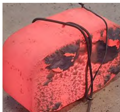
Rysunek 10.1. Próbkę do badań szybkości chłodzenia a) próbka przed pomiarem b) próbki w trakcie pomiaru
