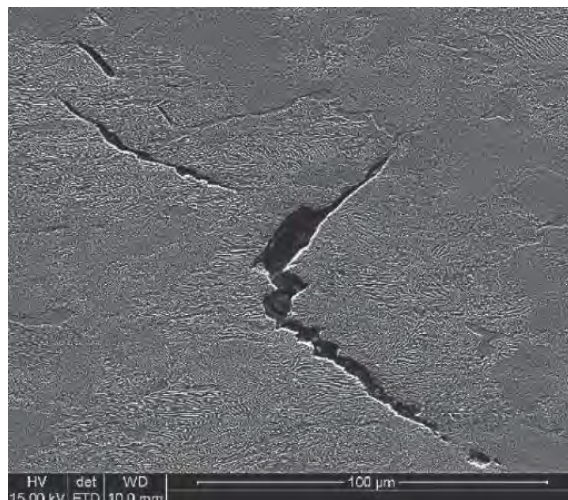
Rysunek 2.10. Mikrostruktura drutu o średnicy 4,8 mm po ciągnięciu walcówki ze stali C70D2 a) propagacja pęknięć w koloniach perlitu grubopłytkowego oraz a) miejsce zarodkowania pęknięć w obszarach ferrytu przedeutektoidalnego [25]
