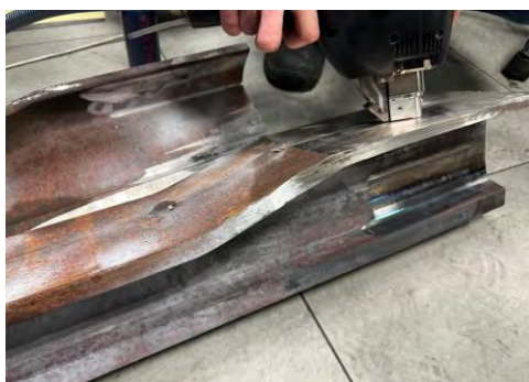
Rysunek 6.1. Pomiar składu spektrometrem a) lokalizacja badań miejsca pomiaru dla próbek a) przed OC b) po OC
