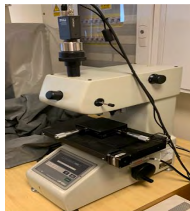
Rysunek 6.2. Pomiar twardości a) Twardościomierz Leeb Lpad H110 b) powierzchnia toczna przed wykonaniem pomiaru twardości c) twardościomierz LECO LM 100 AT
