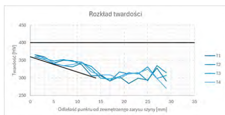
Rysunek 14.6 Rozkład twardości na powierzchni główki szyny dla osiągniętej szybkości chłodzenia a) na stanowisku przemysłowym z szybkością 3,08\text{ }^{\circ}\text{C/s} b) na stanowisku laboratoryjnym z szybkością 5\text{ }^{\circ}\text{C/s}
