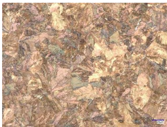
Rysunek 14.3. Mikrostruktury pobrane z tego samego miejsca na przekroju główki szyny, odpowiednio dla przekrojów a) Q1_OC_1 z widoczną siatką ferrytu na granicach dawnych ziaren austenitu oraz b) Q3_OC_2 uporządkowana struktura bez wydzieleni ferrytu
