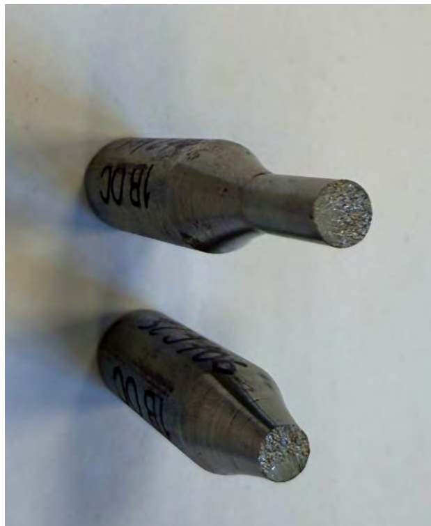
Rysunek 9.10. próbka wycięta ze strefy 1B_OC a) po przeprowadzeniu 5 \cdot 10^6 cykli b) po przeprowadzeniu 2,71 \cdot 10^6 z większym obciążeniem
