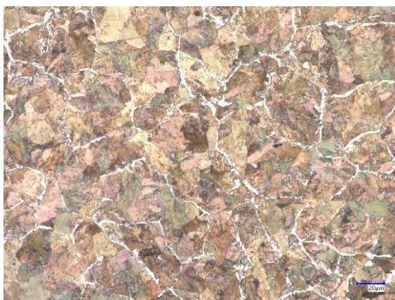
Rysunek 14.3. Mikrostruktury pobrane z tego samego miejsca na przekroju główki szyny, odpowiednio dla przekrojów a) Q1_OC_1 z widoczną siatką ferrytu na granicach dawnych ziaren austenitu oraz b) Q3_OC_2 uporządkowana struktura bez wydzieleni ferrytu
