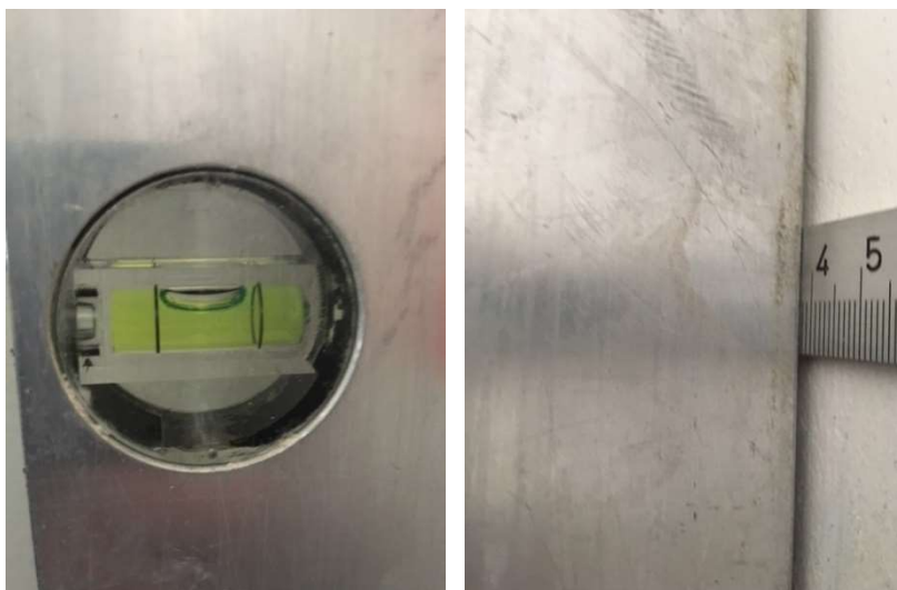
Rys. 12 Widok łąty i libelli w trakcie pomiaru odchylenia od pionu. [Źródło własne]
