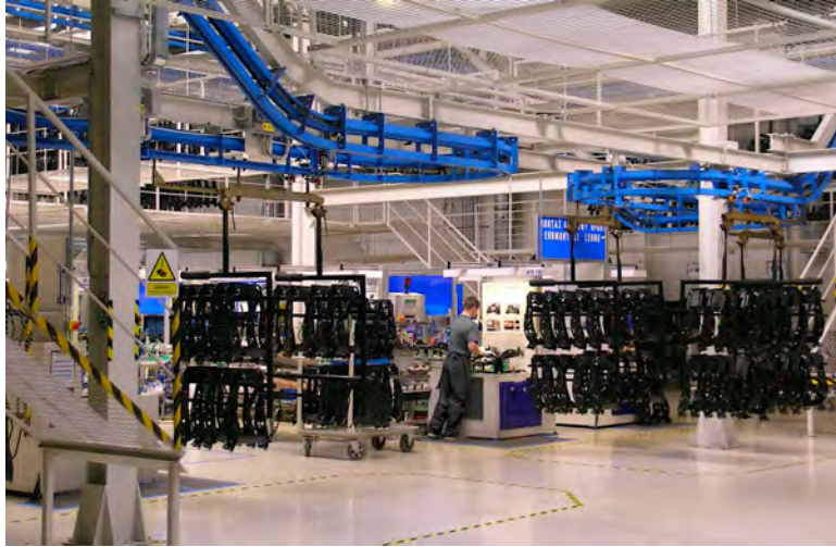
Rysunek 6.5: Zdjęcie systemu kołowo-karuzelowego po lakierni na hali nr I (KTL) w zakładzie Brose Sitech Sp. z o.o. w Polkowicach [153]
