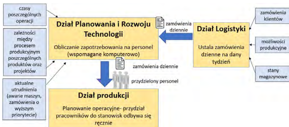
Rysunek 6.13: Schemat planowania produkcji w przedsiębiorstwie
