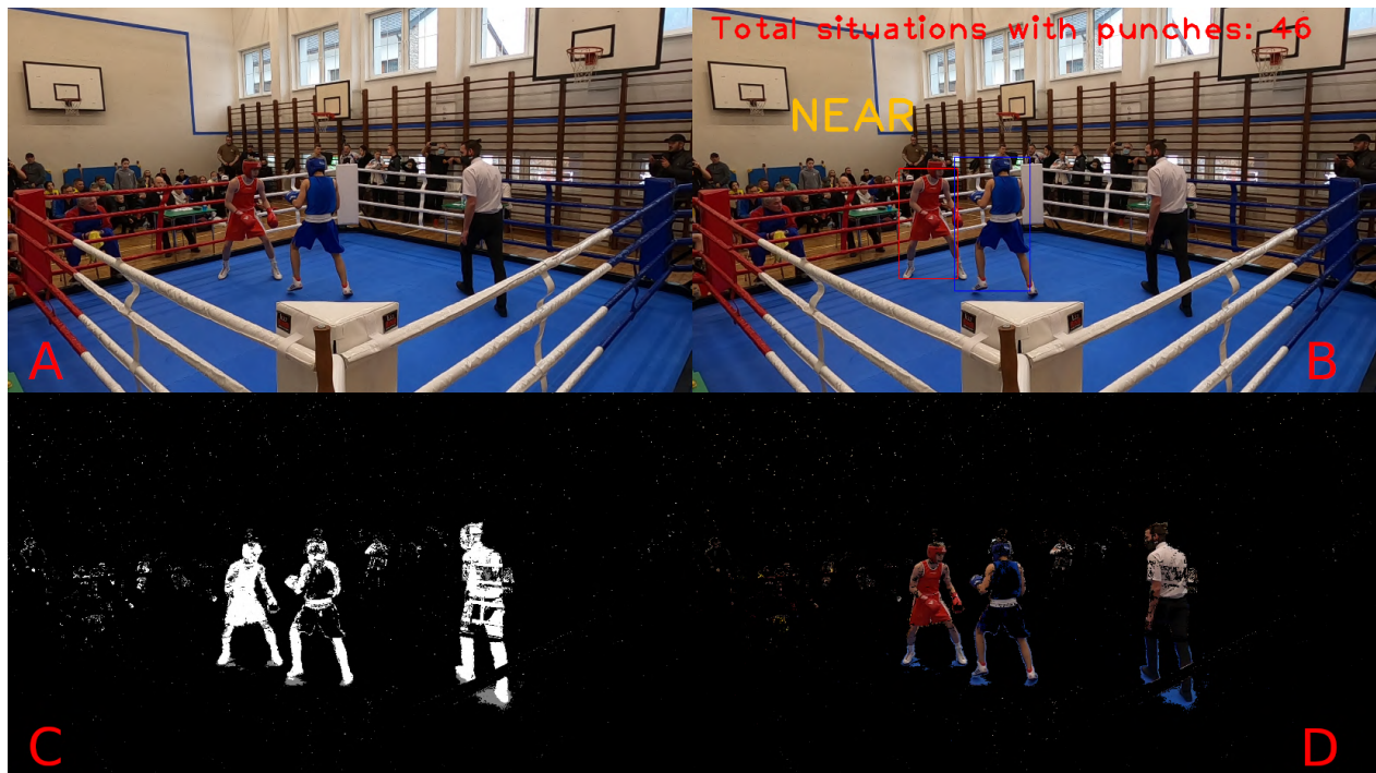
Rysunek 5.18: Przegląd całego potoku przetwarzania dla sytuacji walki wręcz bez ciosów. A: oryginalny obraz; B: oryginalny obraz z informacją o wykrytych zdarzeniach; C: maska proponowanego podejścia 3; D: oryginalny obraz z zastosowaną maską proponowanego podejścia 3
