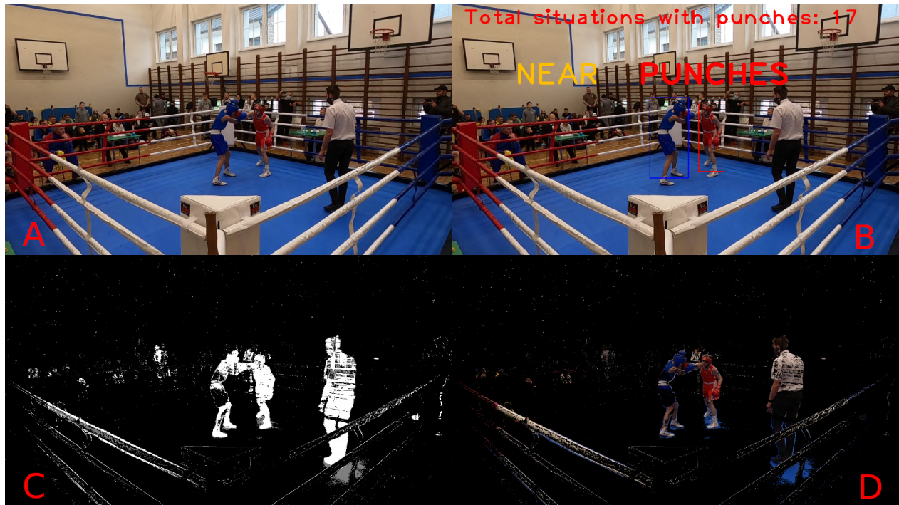
Rysunek 5.17: Przegląd całego potoku przetwarzania dla sytuacji z ciosem. A: oryginalny obraz; B: oryginalny obraz z informacją o wykrytych zdarzeniach; C: maska proponowanego podejścia 3; D: oryginalny obraz z zastosowaną maską proponowanego podejścia 3
