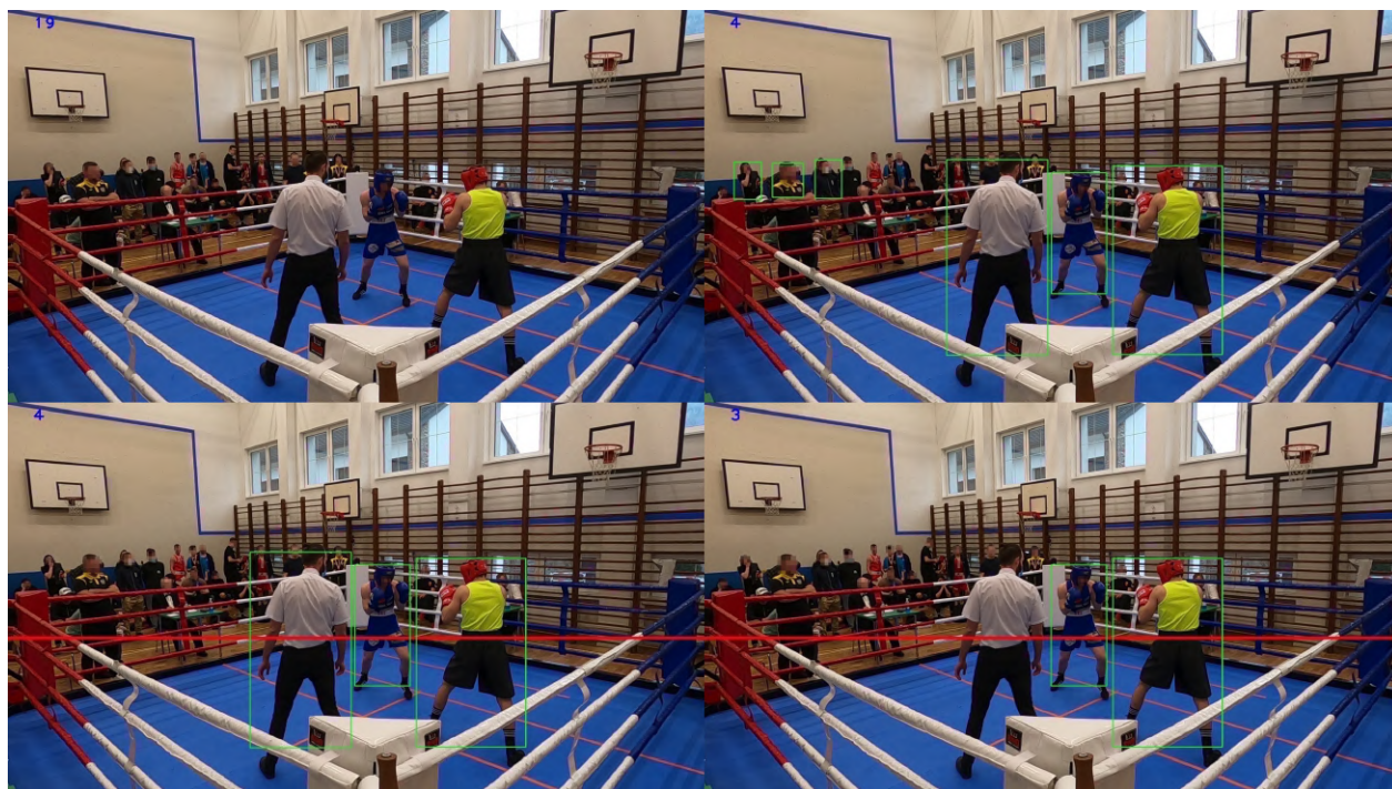
Rysunek 5.2: Wykrywanie zawodników z zastosowaniem opisanych technik
