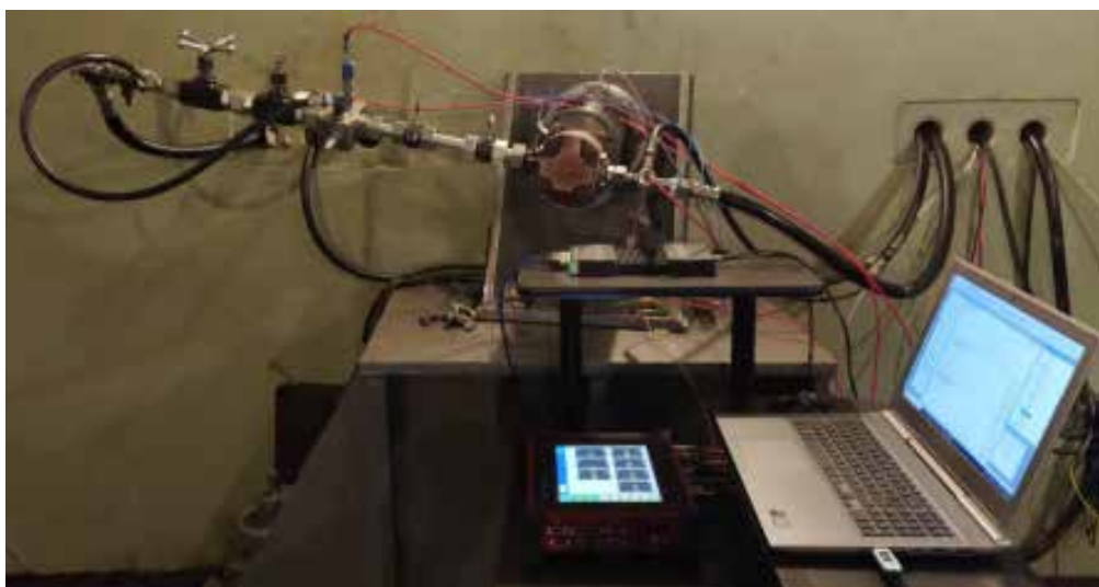
Rys. 6.18. Stanowisko badawcze do wyznaczania pulsacji wydajności pomp z badaną pompą prototypową
