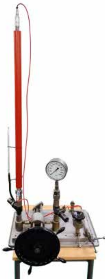
Rys. 6.19. Stanowisko badawcze przeznaczone do wyznaczania modułu sprężystości objętościowej oleju
