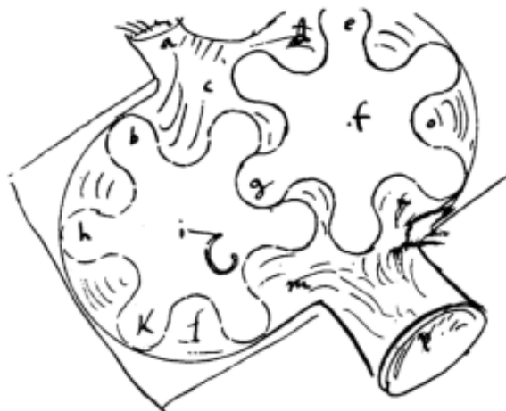
Rys. 1.4. Pompa zębata Keplera narysowana przez Wilhelma Schickarta w 1618 roku prawdopodobnie na podstawie szkiców Keplera [18]
