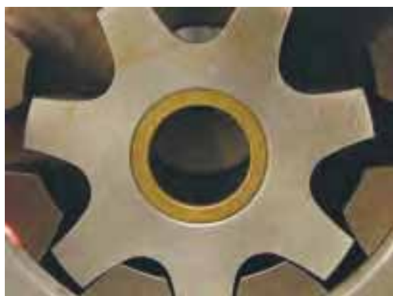
Rys. 1.12. Pompa z zarysem Taocloid wg patentu japońskiego nr JP 2845174 [62]. 1 – kanał ułatwiający wypływ, 2, 3, 4 – kanały ułatwiające napływ czynnika roboczego
