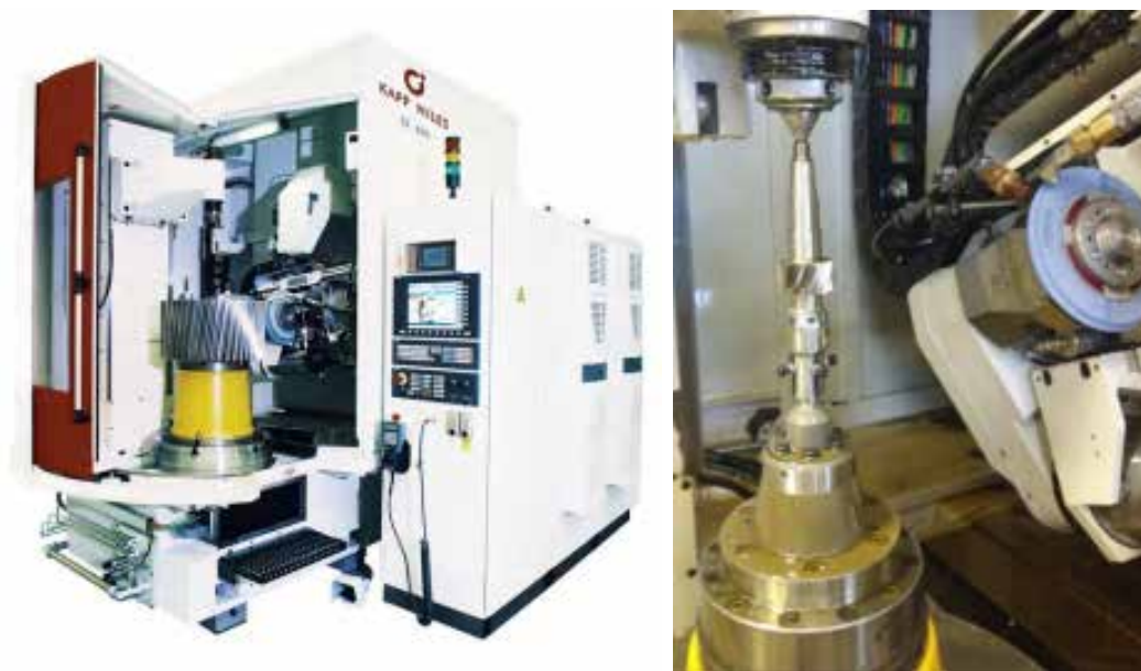
Rys. 5.3. Szlifierka KAPP NILES ZE 800 wykorzystana do wykonania prototypowych kół zębatach (po lewej), koło zębata w uchwycie maszyny po zakończonym procesie szlifowania (po prawej)
