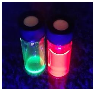
Rysunek 51. Zdjęcie rdzeni dwuwymiarowych CdSe zsyntezowanych metodą HI świecących na zielono oraz struktur rdzeń/płaszcz CdSe/CdZnS świecących na czerwono w roztworach. Nanokryształy wzbudzono lampą UV ( \lambda = 405 \text{ nm} ).
