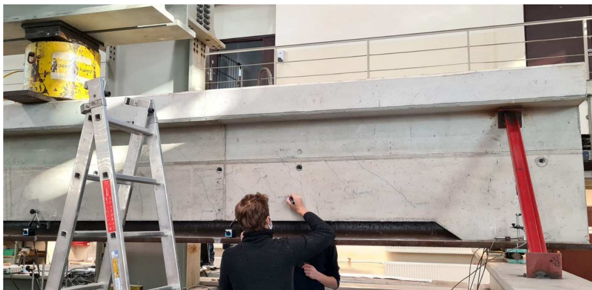
Rys. 6.2 Inwentaryzacja rys w początkowej fazie obciążenia
