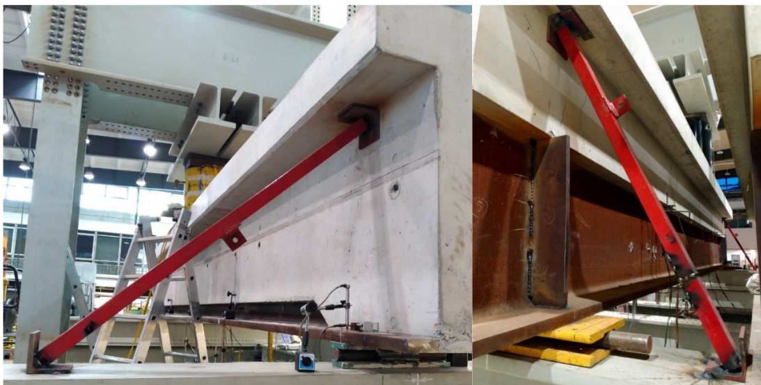
Rys. 6.15 Łożyska wałkowe i elementy zabezpieczające półkę górną przed przesuwem poprzecznym w strefach podporowych belki SRCD-1 i belki S1-200
