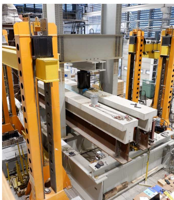
Rys. 6.14 Schemat elementów stanowiska badawczego 1- słup, 2 – poprzecznice górne, 3 – podporowa belka podłużna, 4 – element węzłowy, 5 i 6 elementy przesuwne zapewniające możliwość podparcia belek, 7 – elementy umożliwiające rozkład obciążenia z siłownika na obie poprzecznice
