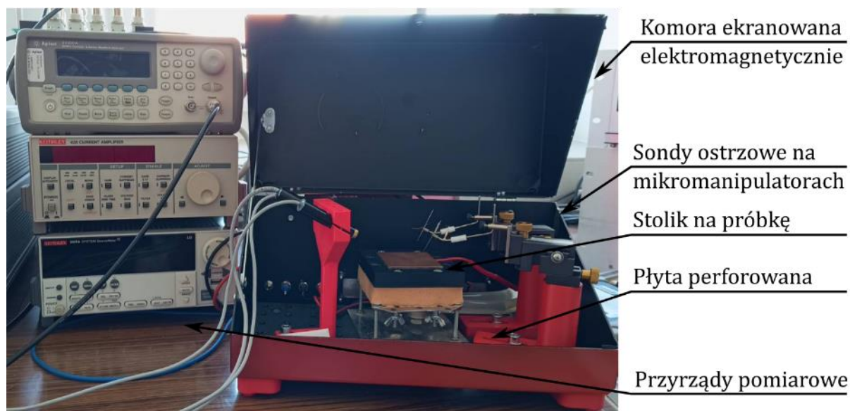
Rysunek 21. Komora pomiarowa ekranowana elektromagnetycznie według projektu dr. hab. inż. Tomasza Piaseckiego. Układ zawiera wszystkie elementy niezbędne do prowadzenia pomiarów mikrostruktur elektrycznie przewodzących i elementów electronicznych.
