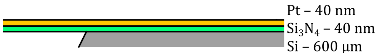
Rysunek 11. Schemat materiałowy opMEMS-Si 3 N 4 .
