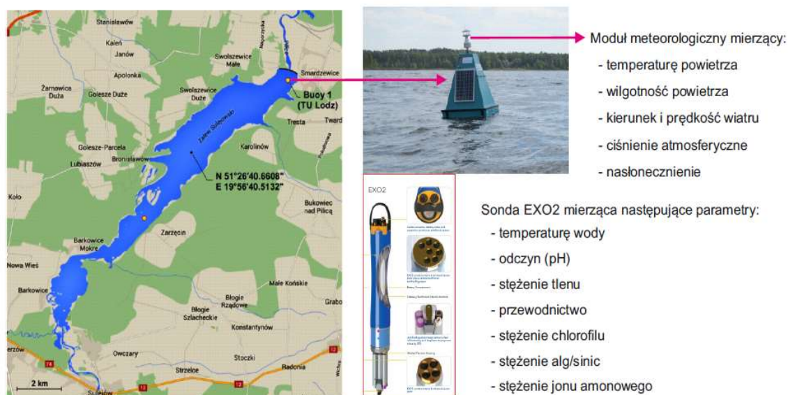
Rysunek 9. Lokalizacja i fotografia stacjonarnego systemu pomiaru parametrów jakości wody oraz danych meteorologicznych, zainstalowanego na Zalewie Sulejowskim.
