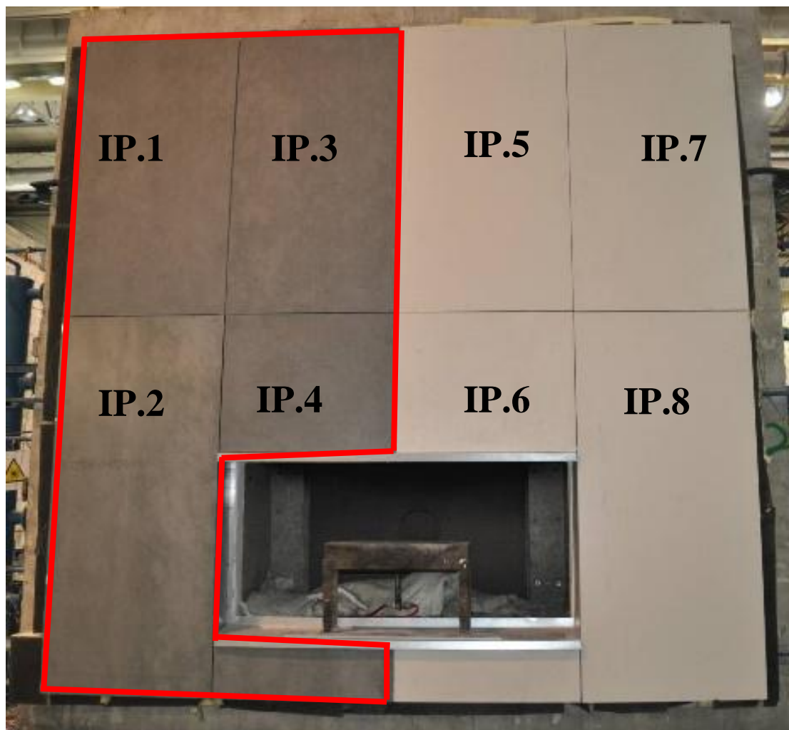
Rys. 5.17. Model rzeczywisty elewacji wentylowanej dla serii badań I
