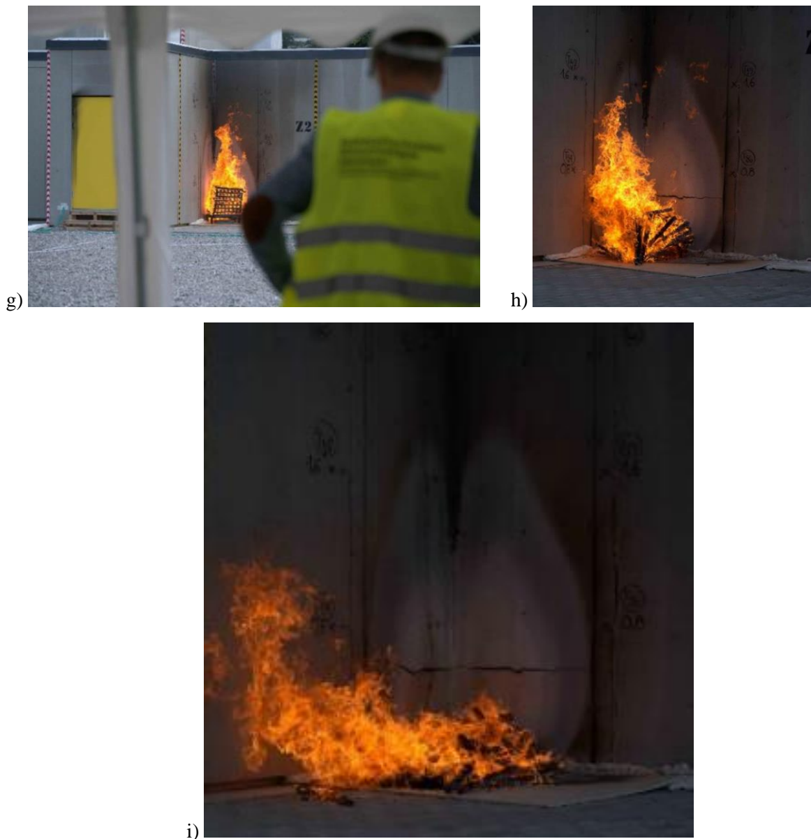
Rys. 5.14. Przebieg badania modelu rzeczywistego w teście skali naturalnej serii G: a) 1'00" badania; b) 2'00" badania; c) 3'00" badania; d) 4'00" badania; e) 7'00" badania; f) 8'00" badania; g) 9'00" badania; h) 13'00" badania; i) 14'00" badania
