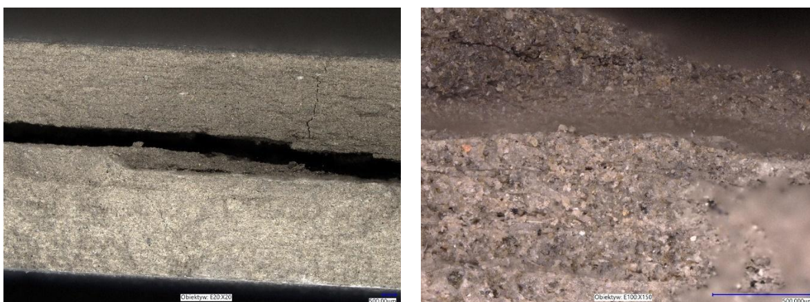
Rys. 5.56. Przekrój próbki D5 z wykorzystaniem mikroskopu cyfrowego
