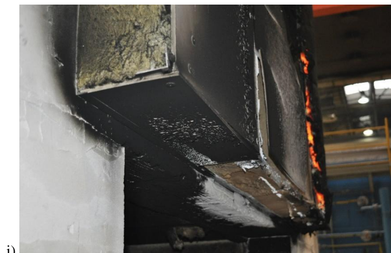
Rys. 5.2. Przebieg badania modelu rzeczywistego w teście skali naturalnej serii badań A: a) 15'30" – widoczna duże zniszczenie płyty AP.4; b) 22'00" – znacząca zniszczenie płyty AP.6; c) 22'00" – widoczne jest różne zachowanie się materiałów na elewacji; d) 28'00" – spadają całe elementy płyt AP.5 i AP.6; e) 36'00" – widoczny rozwój zniszczenia w płytach AP.7 i AP.8; f) 45'00" – spadają kolejne elementy; g) widok okładziny elewacyjnej po badaniu; h) widok okładziny elewacyjnej po badaniu; i) widok okładziny elewacyjnej po badaniu, widoczny nit przytrzymujący płytę AP.4 przed odpadnięciem w całości
