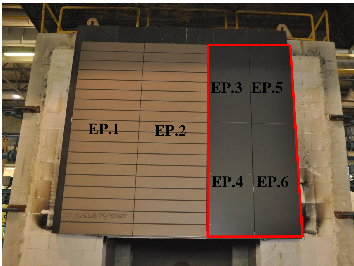
Rys. 5.9. Model rzeczywisty elewacji wentylowanej dla serii badań E
