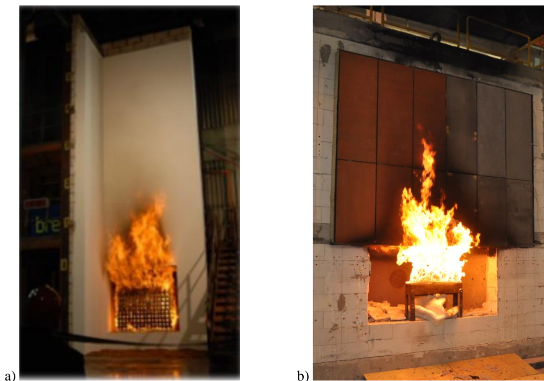
Rys. 3.6. Badanie w zakresie oddziaływania pożarem modeli rzeczywistych elewacji: a) w teście dużej skali [64]; b) w teście średniej skali
