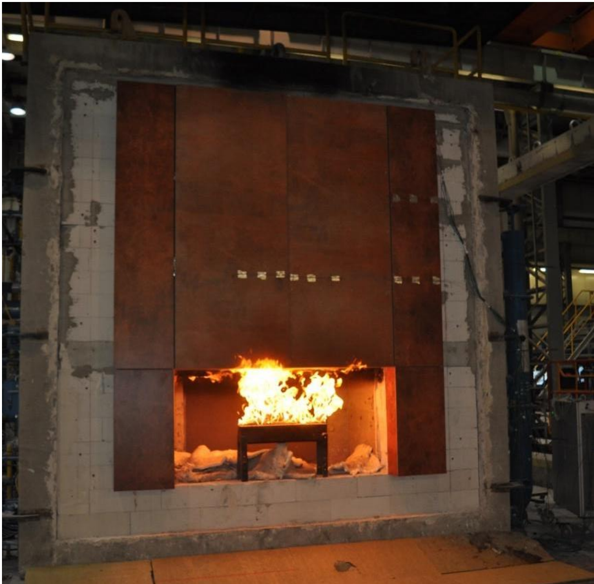
Rys. 4.3. Przykładowe badanie oddziaływania pożarem na modelu rzeczywistym przy procedurze ITB – procedura PB LP-091/1/11-2014 [80]
