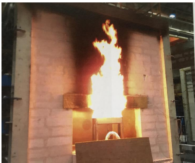
Rys. 4.4. Widok zaplecza stanowiska badawczego przy procedurze ITB – procedura PB LP-091/1/11-2014 [80]
