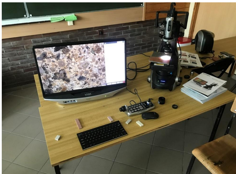
Rys. 4.24. Mikroskop cyfrowy Keyence VH×-7000 series
