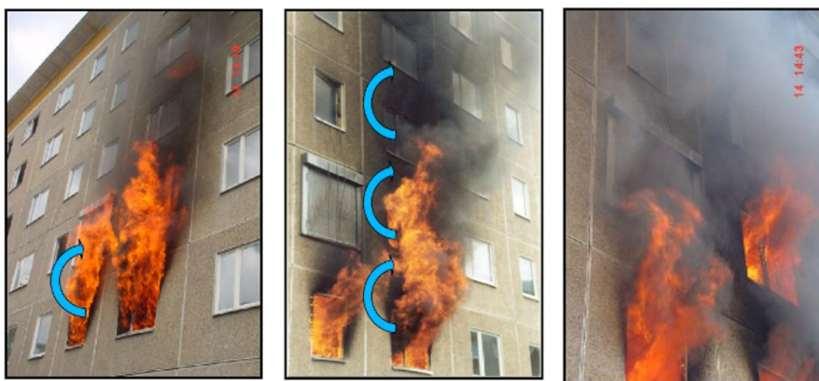
Rys. 3.13. Rozwój rzeczywistego pożaru przez mechanizm przeskoiku pomiędzy kondygnacjami po elewacji [48]: a) 12'00" minuta pożaru – płomienie wydobywają się z pierwszej kondygnacji; b) 20'00" minuta pożaru – płomienie przedostają się na drugą kondygnację; c) 25'00" minuta pożaru – płomienie przedostają się również w poziomie pomiędzy oknami [89]
