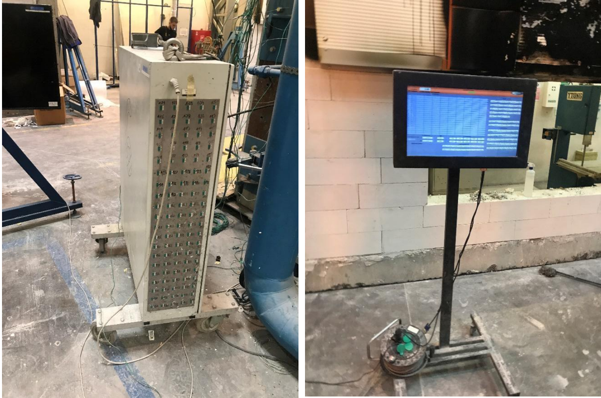
Rys. 4.11. Osprzęt odpowiadający za przetwarzanie i przedstawianie wyników z termopar Źródło: Materiały własne.
