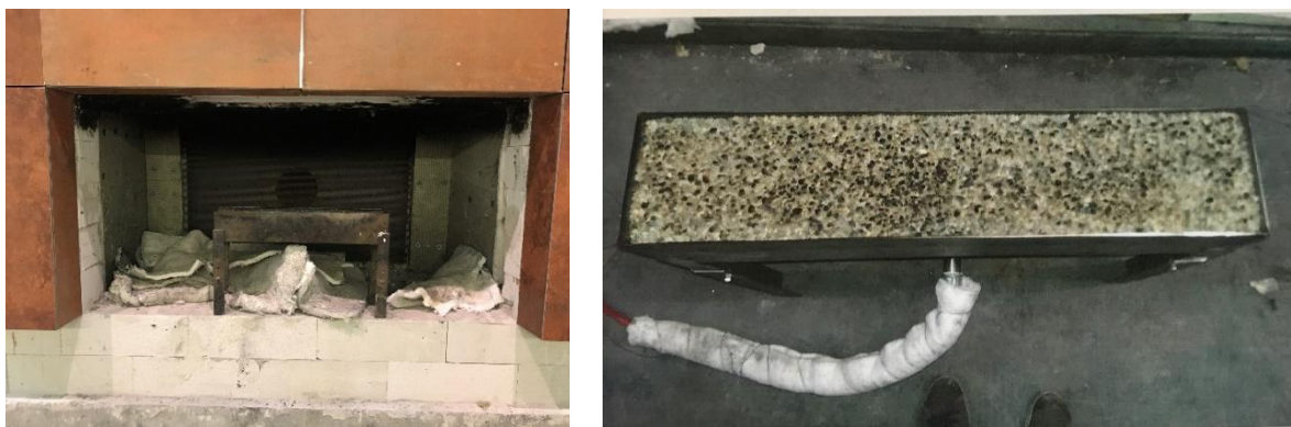
Rys. 4.6. Widok prostopadłościowej komory spalania oraz palnika gazowego
