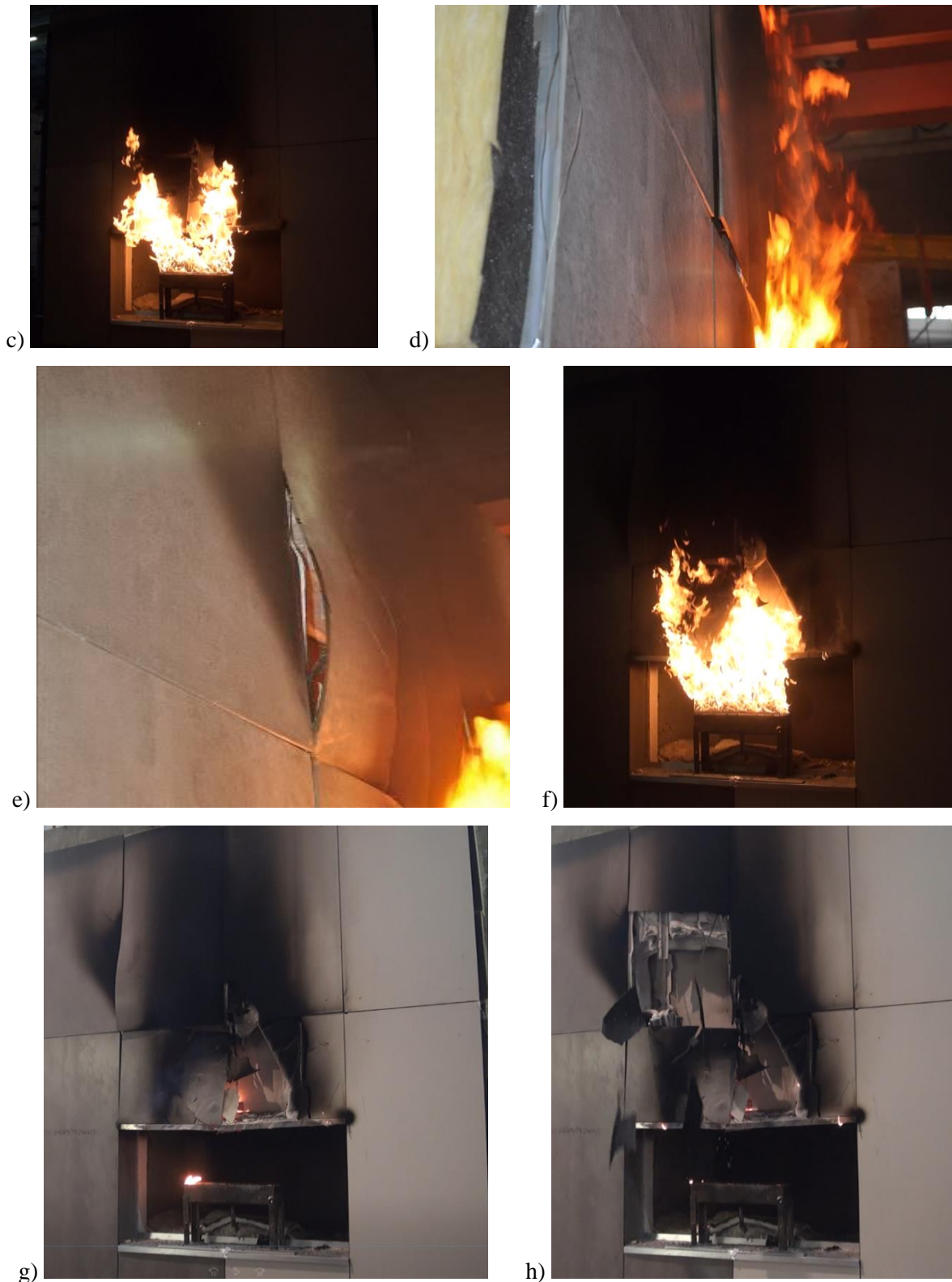
Rys. 5.18. Przebieg badania modelu rzeczywistego w tęście skali naturalnej serii badań I: a) 5'00"; b) 5'30"; c) 10'40"; d) 21'00"; e) 41'00"; f) 45'00"; g) – h) widok po badaniu
