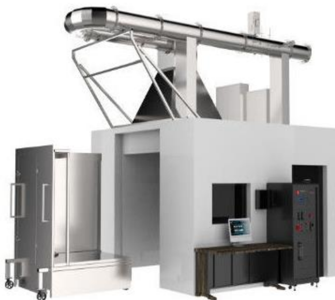
Rys. 3.3. Pomieszczenie oraz platforma badawcza do badania klasy reakcji na ogień wg PN-EN 13823:2010 [118]
