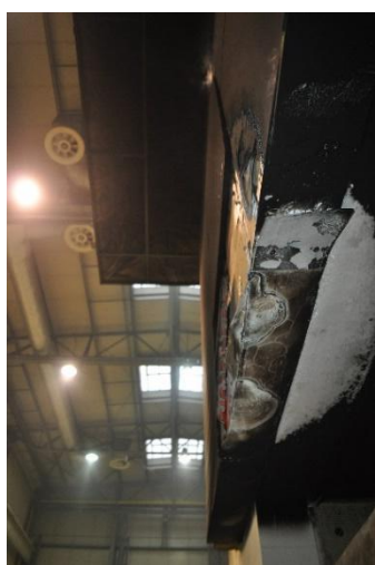
Rys. 5.10. Przebieg badania modelu rzeczywistego w teście skali naturalnej serii E: a) 11'00"; b) 15'00"; c) 32'00"; d) 46'00"; e) 59'00"; f) 59'00"; g) – i) widok okładziny elewacyjnej po badaniu
