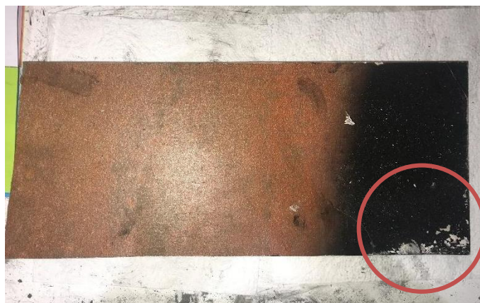
Rys. 5.70. Widok elementu, który spadł z modelu podczas badania o oznaczeniu D1/D2
