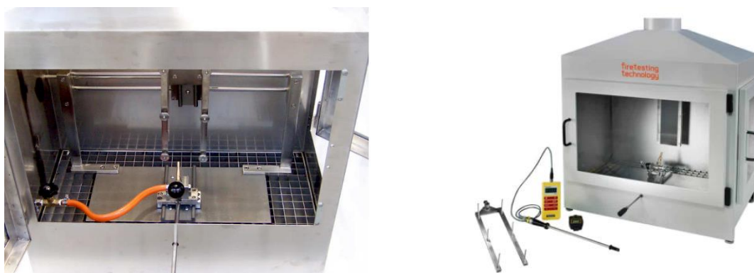
Rys. 3.4. Komora spalania wg EN ISO 11925-2 [123]
