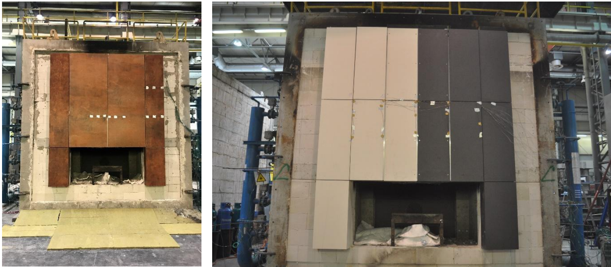
Rys. 4.12. Modele rzeczywiste elewacji przygotowane do badań. Źródło: Materiały własne.
