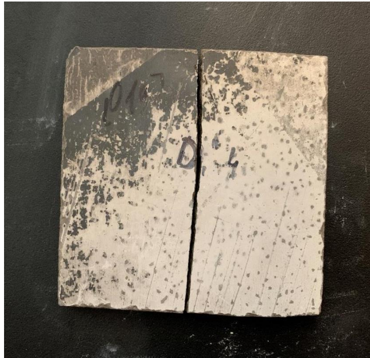
Rys. 5.78. Widok zniszczonej próbki D4 (nr 019) po próbie zginania w maszynie wytrzymałościowej
