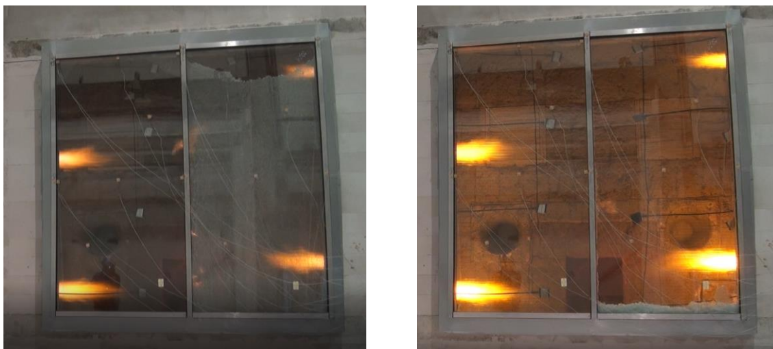
Rys. 3.10. Zachowanie zespolonego przeszklenia podczas standardowego oddziaływania ognia.
