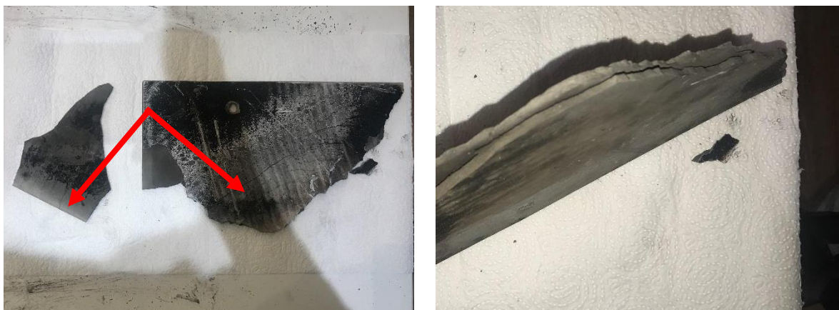
Rys. 5.55. Widok element D5, która spadła z modelu wielkoskalowego podczas badania
