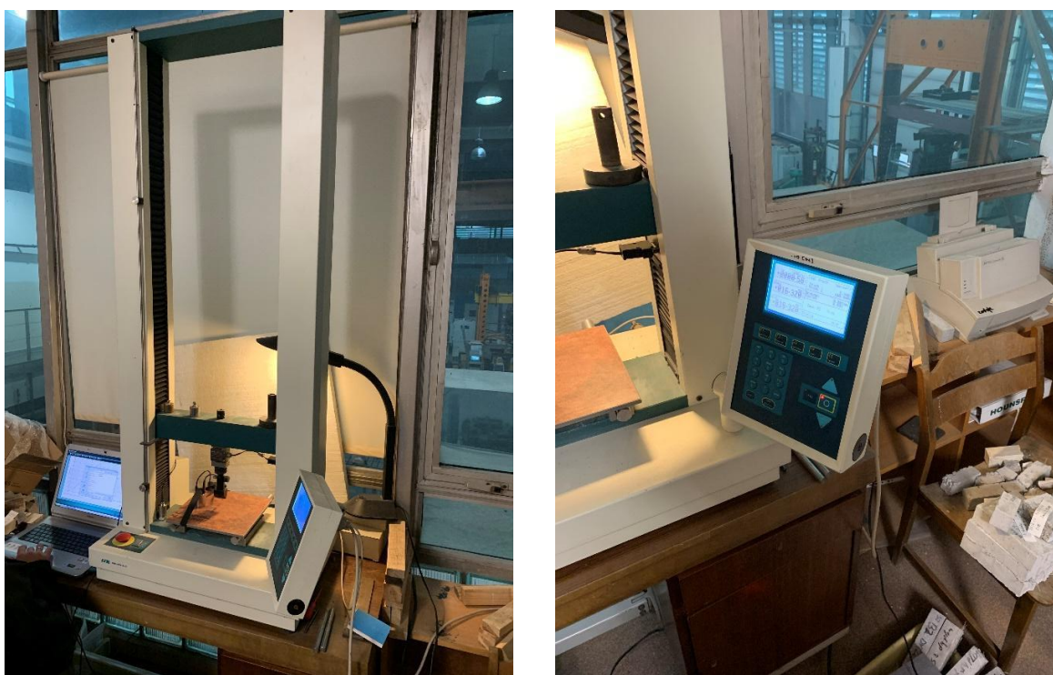
Rys. 4.21. Maszyna wytrzymałościowa do badania wytrzymałości na zginanie MOR
