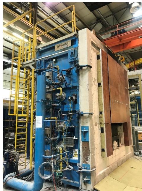
Rys. 4.5. Widok pieca badawczego Spark
