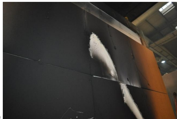
Rys. 5.4. Przebieg badania modelu rzeczywistego w teście skali naturalnej serii badań B: a) 5'00"; b) 6'00"; c) 15'00"; d) 20'00"; e) 45'00"; f) 59'00"; g) widok okładziny elewacyjnej po badaniu; h) widok okładziny elewacyjnej po badaniu; i) widok okładziny elewacyjnej po badaniu
