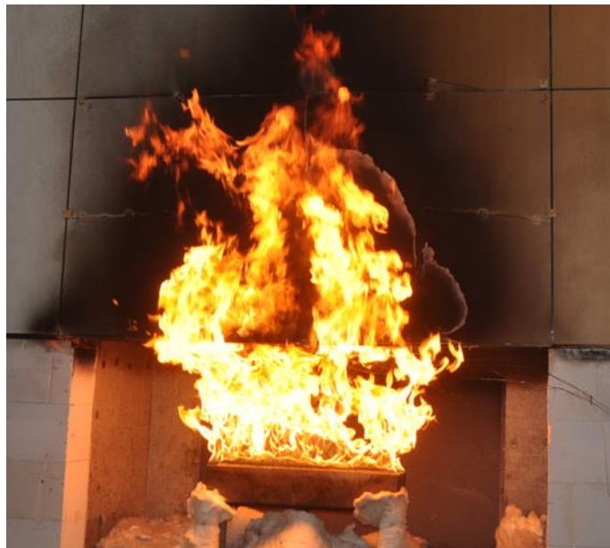
Rys. 5.22. Przebieg badania modelu rzeczywistego w serii badań B w 6'00" minucie
