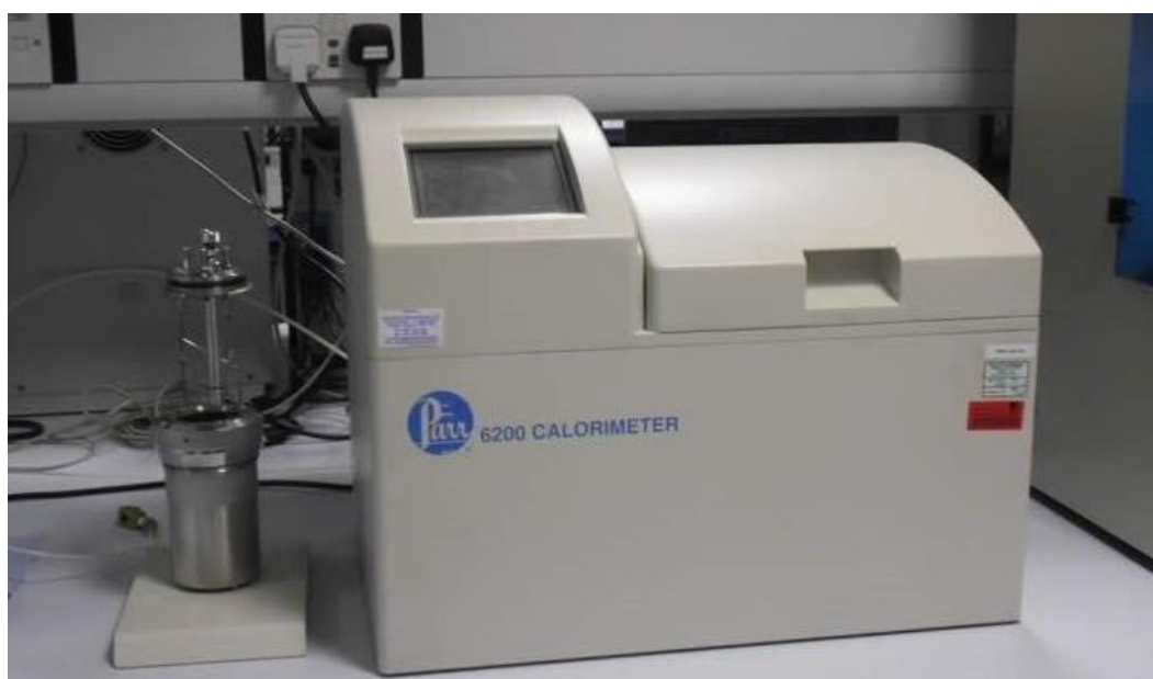
Rys. 3.2. Bomba kalorymetryczna wg PN-EN ISO 1716 [124]
