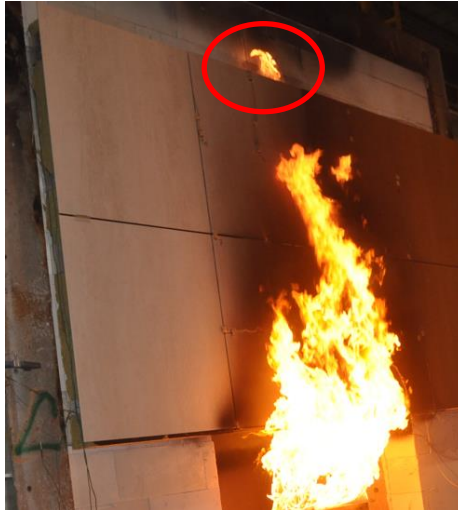
Rys. 5.24. Płomienie wewnątrz przestrzeni wentylacyjnej w 5'00" minucie badania dla serii B
