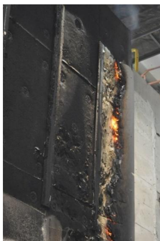
Rys. 5.2. Przebieg badania modelu rzeczywistego w teście skali naturalnej serii badań A: a) 15'30" – widoczna duże zniszczenie płyty AP.4; b) 22'00" – znacząca zniszczenie płyty AP.6; c) 22'00" – widoczne jest różne zachowanie się materiałów na elewacji; d) 28'00" – spadają całe elementy płyt AP.5 i AP.6; e) 36'00" – widoczny rozwój zniszczenia w płytach AP.7 i AP.8; f) 45'00" – spadają kolejne elementy; g) widok okładziny elewacyjnej po badaniu; h) widok okładziny elewacyjnej po badaniu; i) widok okładziny elewacyjnej po badaniu, widoczny nit przytrzymujący płytę AP.4 przed odpadnięciem w całości
