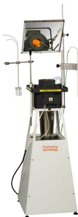
Rys. 3.1. Przykładowy piec rurowy [75]
