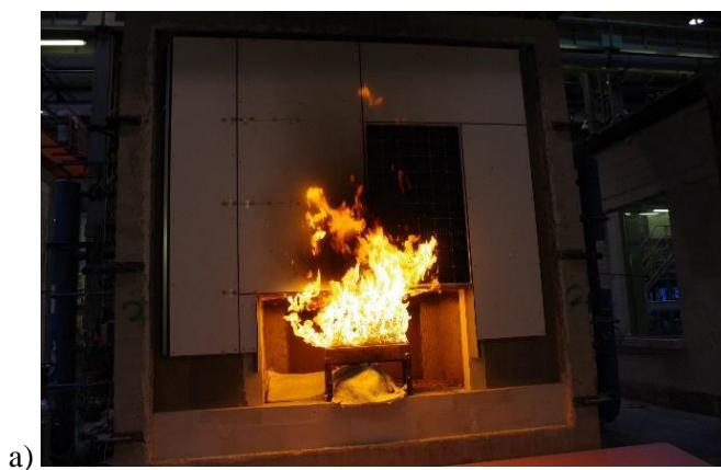
Rys. 5.19. Model rzeczywisty elewacji wentylowanej dla serii badań J
