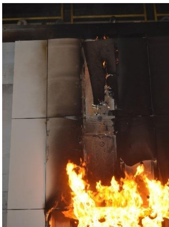
Rys. 5.26. Powolna stabilizacja fazy I po wypaleniu się materiałów palnych w 25'00'' minucie badania dla serii C
