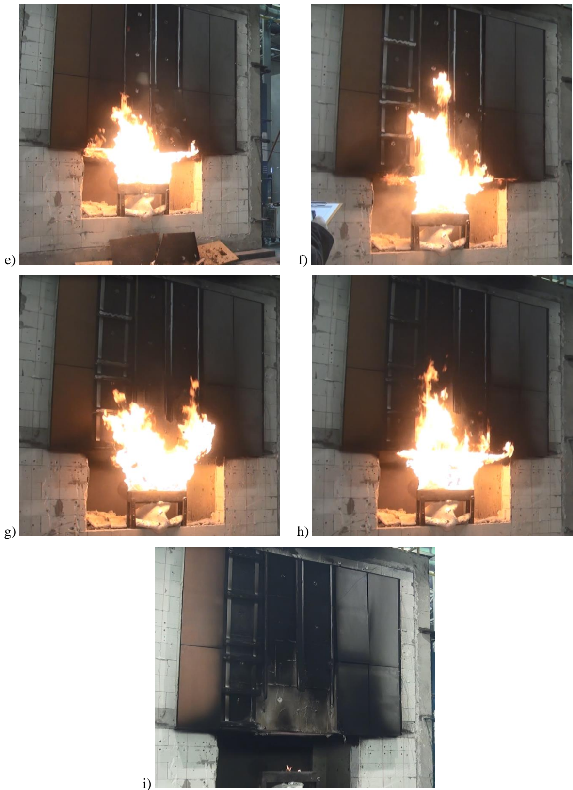
Rys. 5.16. Przebieg badania modelu rzeczywistego w teście skali naturalnej serii badań H: a) 3'00"; b) 3'30"; c) 5'20"; d) 6'40"; e) 7'40"; f) 11'00"; g) 22'00"; h) 53'00"; i) widok okładziny elewacyjnej po badaniu
