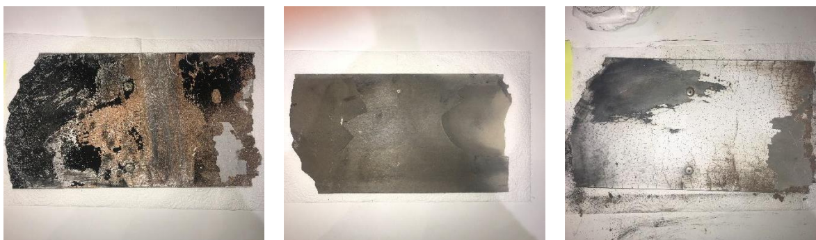
Rys. 5.62. Widok elementu, który odpadł z modelu podczas badania o oznaczeniu D3
