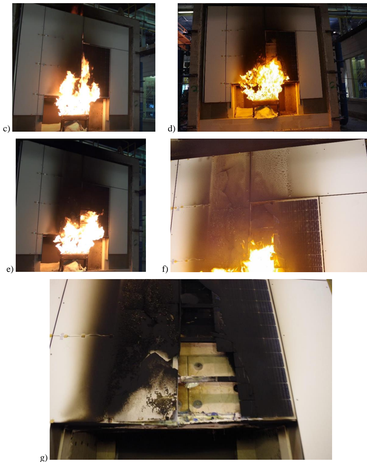
Rys. 5.20. Przebieg badania modelu rzeczywistego w teście skali naturalnej serii badań J: a) 1'30"; b) 3'00"; c) 4'50"; d) 15'50"; e) 41'00"; f) 120'00"; g) po badaniu
