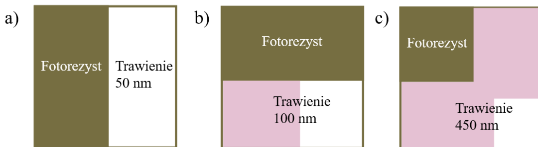
Rys. 8.12 - Schemat trawienia na mokro.
