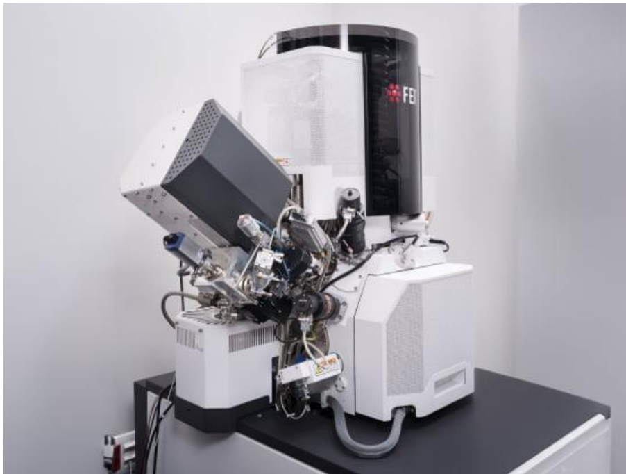
Rys. 3.5 - Zdjęcie mikroskopu dwuwieżkowego SEM/Xe-PFIB FEI Helios G4 PFIB CXe w siedzibie laboratorium firmy Nanores (za zgodą firmy Nanores).
