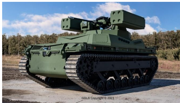
Rys. 1.22. Prototyp robota do zastosowań militarnych skonstruowany w oparciu o platformę gaśnicową RIwP [i24]
