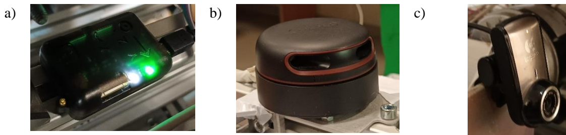
Rys. 7.14. Czujniki pojazdu OMP2024_2: a) NGIMU, b) RPLidar, c) kamera RGB
