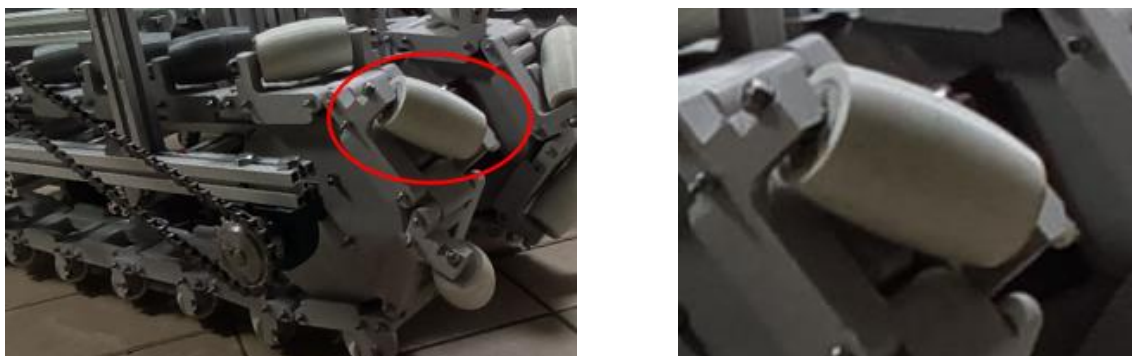
Rys. 7.3. Widok pojedynczej baryłkowatej swobodnej rolki tocznej
