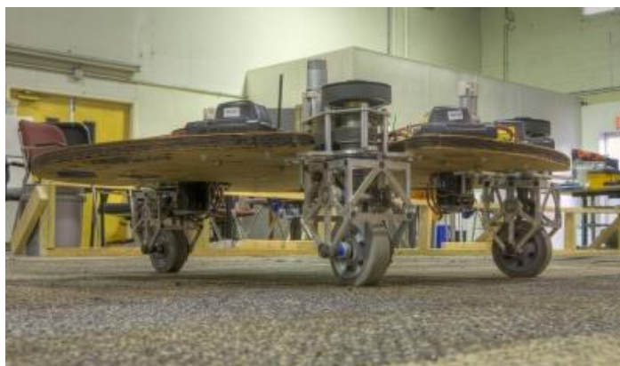
Rys. 1.31. Robot omnikierunkowy wyposażony w indywidualnie skręcane koła walcowe [i31]
