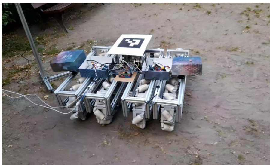
Rys. 8.29. Widok pojazdu OMP2024_2 podczas wykonywania przejazdu testowego po trajektorii \mu^T po podłożu piaszczystym
