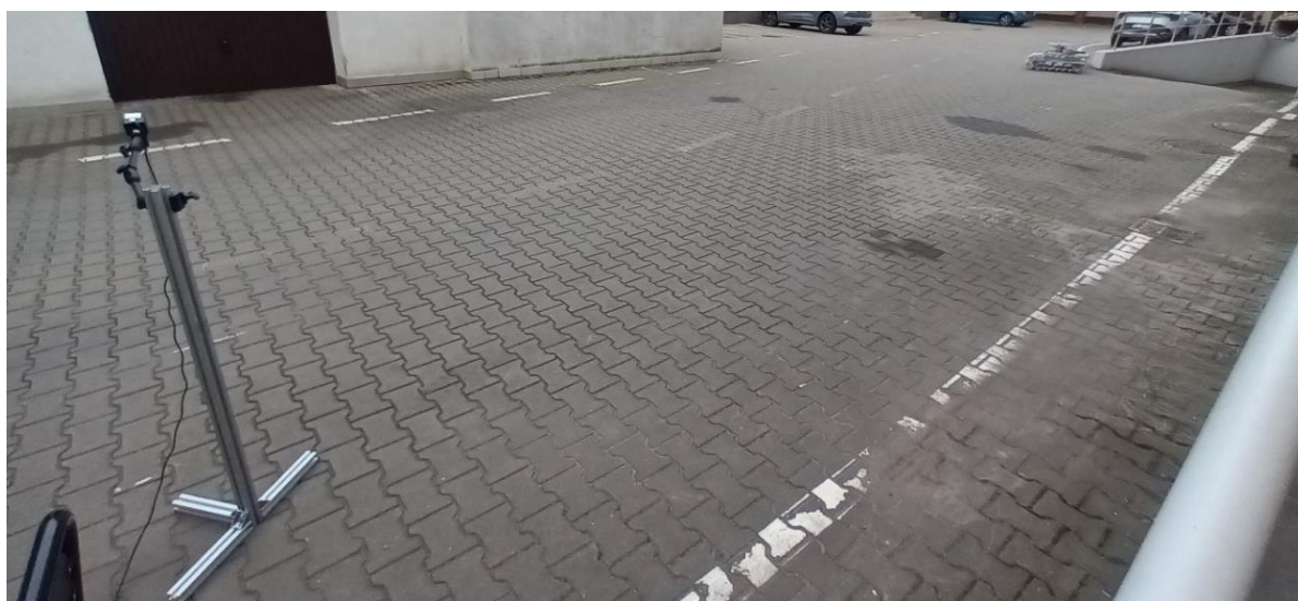
Rys. 8.20. Widok stanowiska do pomiaru parametrów jazdy pojazdu omnigąsienicowego w warunkach rzeczywistych na podłożu z kostki brukowej wraz z robotem OMP2024_2
