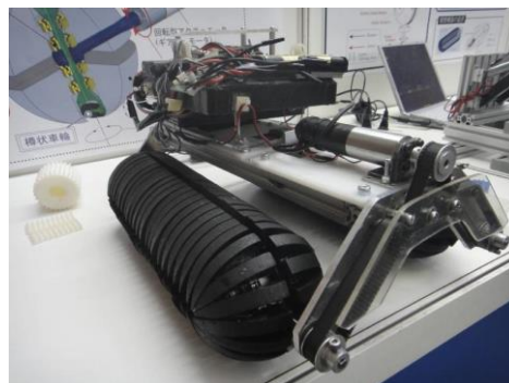
Rys. 1.49. Przykład łazika wykorzystujący gąsienice oparte o koncepcję koła sferycznego [i42]
