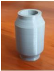
Rolka Walec typu C tworząca – 0,054 m, wysokość – 0,068 m
