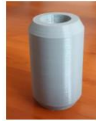
Rolka Walec typu B tworząca – 0,061 m, wysokość – 0,068 m
