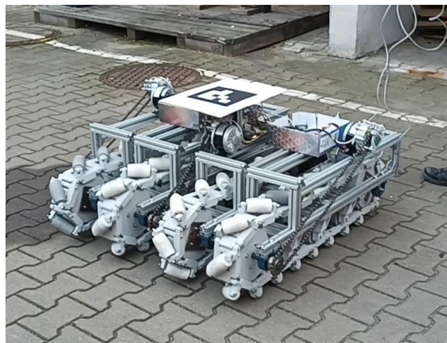
Rys. 8.25. Widok pojazdu OMP2024_2 podczas wykonywania przejazdu testowego po trajektorii \mu^Z po podłożu z kostki brukowej
