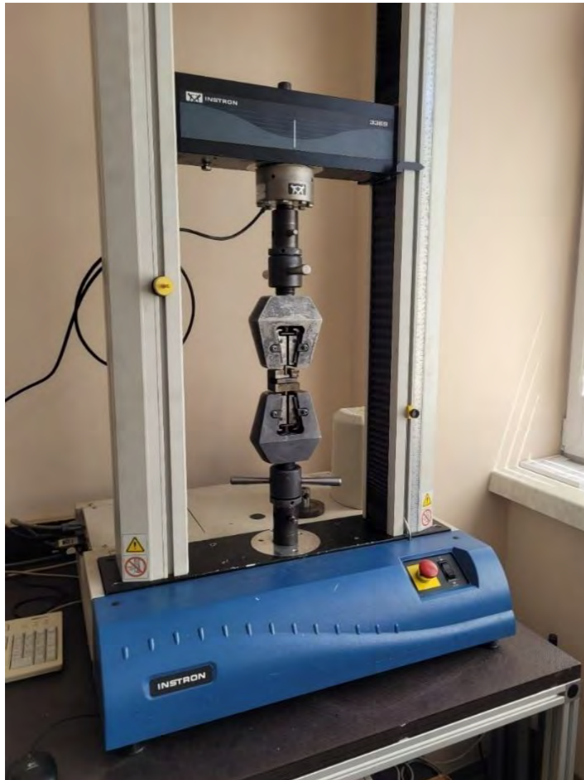
Rys. 15.30 Maszyna wytrzymałościowa firmy INSTRON model 3369 wraz zamocowaną próbką.
