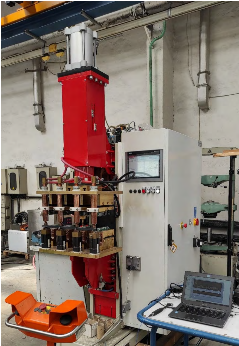
Rys. 11.22 Stanowisko zgrzewalnicze do badania jakości komponentów z zastosowaniem analizy modalnej.
