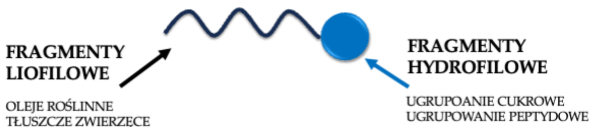
Rysunek 1. Budowa surfaktantu z odnawialnych źródeł surowcowych – schematyczne przedstawienie struktury.
