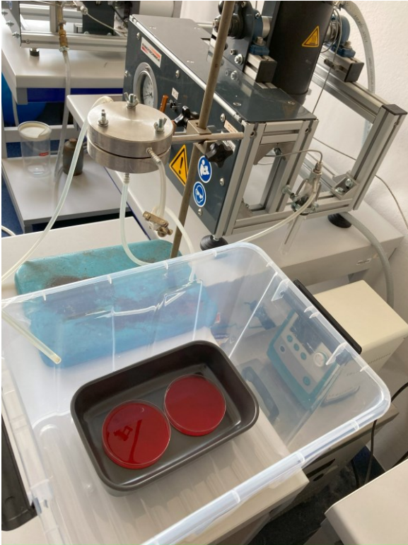
Zdjęcie 2. 2 Zestaw eksperymentalny wdmuchiwania ditlenku węgla do modelu klatki piersiowej z wykorzystaniem modułu filtracyjnego z membraną zaimpregnowaną karwakraolem. Na zdjęciu widoczne są dwie płytki z pożywką agarową
