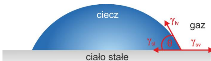
Rysunek 4.1. Metoda pomiaru zwilżalności powierzchni siedzącą kroplą i układ sił.
