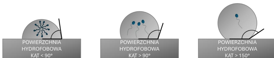
Rysunek 12 Kształt kropli anolitu w zależności od występowania biosurfaktantów i ich stężenia.
