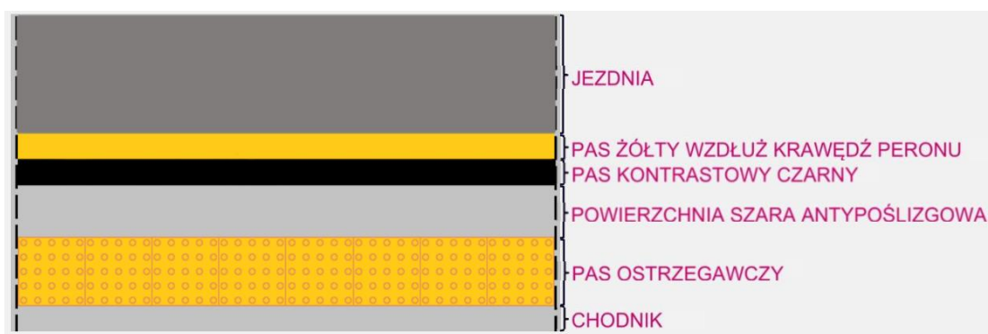
Rys. Z1.15. Sposób projektowania strefy zagrożenia wzdłuż PKD zgodnie z zaleceniami PZN, źródło: [206].
