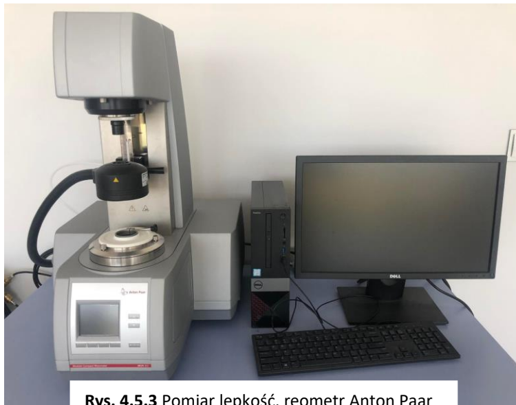
Rys. 4.5.3 Pomiar lepkości, reometr Anton Paar
