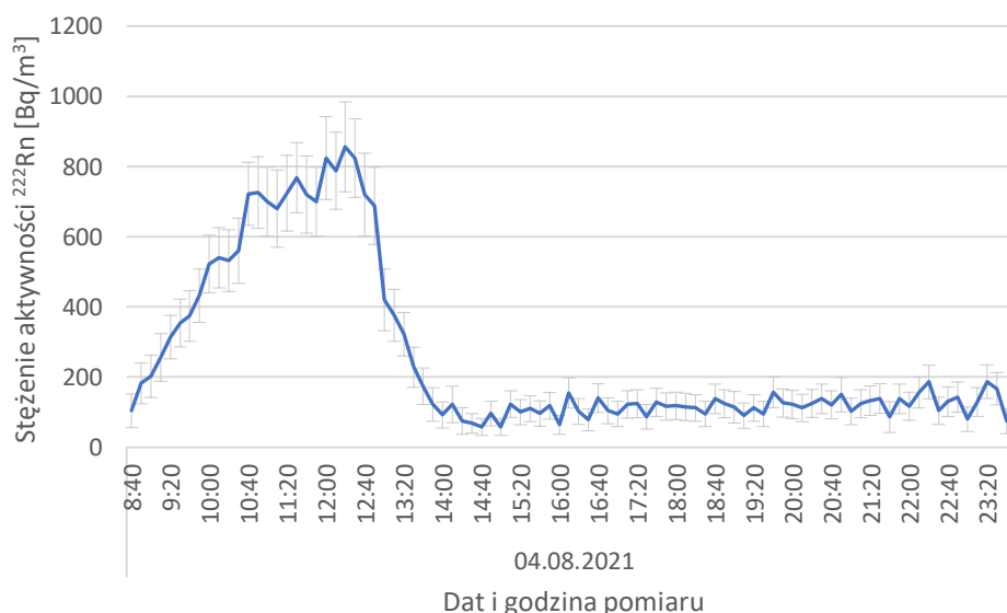
Rys. 36. Stężenie aktywności ^{222}\text{Rn} w powietrzu podczas zabiegów inhalacji radonowych w pomieszczeniu tężni radonowej w uzdrowisku Świeradów-Zdrój w dniu 04.08.2021 r.
