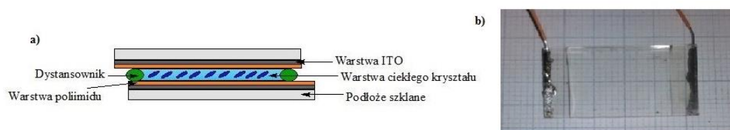
Rysunek 38. (a) Schemat komórki ciekłokrystalicznej i (b) rzeczywisty obraz komórki LC [45] .
