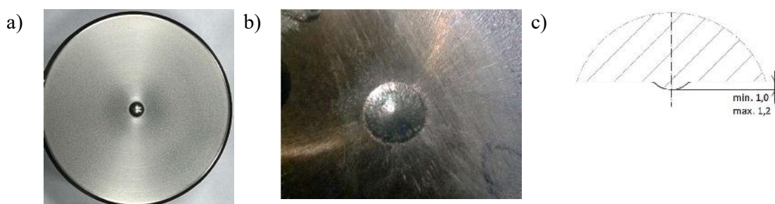
Rys. 62. Widok: a) powierzchni czołowej stempla, b) kalota, c) wymagań dla kaloty wg rysunku konstrukcyjnego – technologia od 2022 roku
