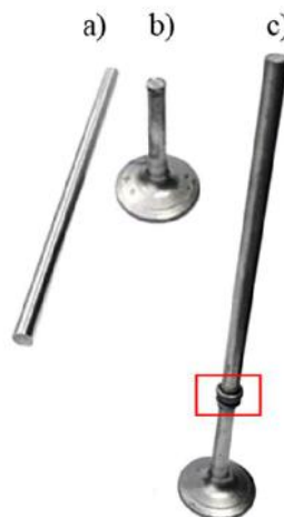
Rys. 46. Komponenty przed i po procesie zgrzewania tarcowego: a) trzonek, b) talerzyk, c) zawór – w czerwonej ramce zaznaczono wypływkę
