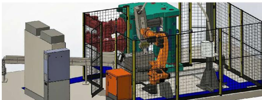
Rys. 32. Wizualizacja stanowiska obsługi walcarki w Kuźni Matrycowej w Lublinie [124]
