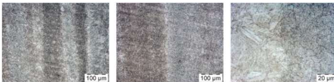
Rys. 22. Mikrostruktura stali 32CrMoV12-28. Mikroskopia świetlna, stan trawiony
