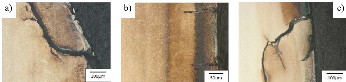
Rys. 87. Zdjęcia powierzchni matrycy wstępnej po eksploatacji dla materiału W360 a) obszar 1, b) obszar 2, c) obszar 3. Mikroskopia świetlna, stan trawiony
