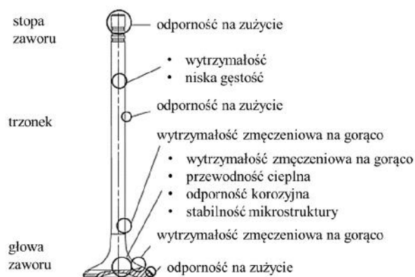
Rys. 2. Konstrukcja zaworu z charakterystycznymi obszarami [12]
