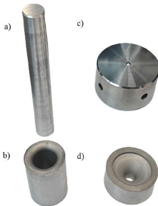
Rys. 48. Widok: a) stempel z I operacji, b) matryca z I operacji, c) stempel z II operacji, d) matryca z II operacji
