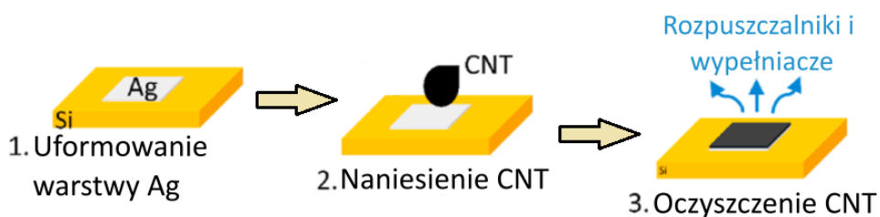
Rys. 3. Schemat procesu technologicznego wykonywania katod polowych CNT z adhezyjną warstwą srebra [A8].
