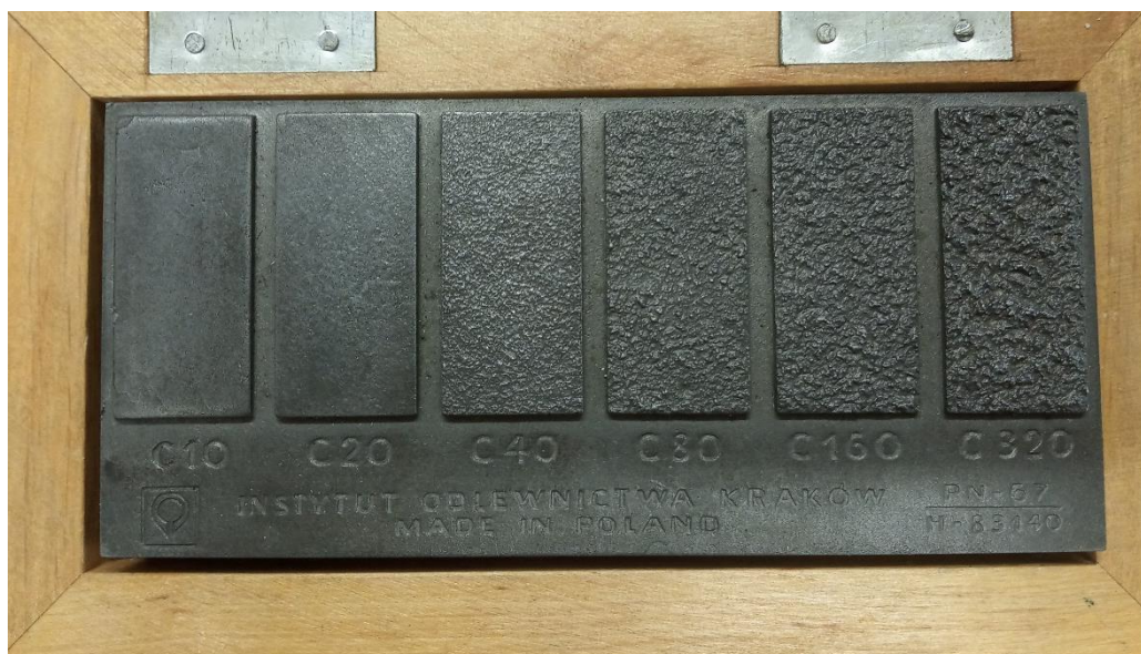
Rysunek 7.6. Wzorzec chropowatości odlewów żeliwnych Instytutu Odlewnictwa C10-C320
