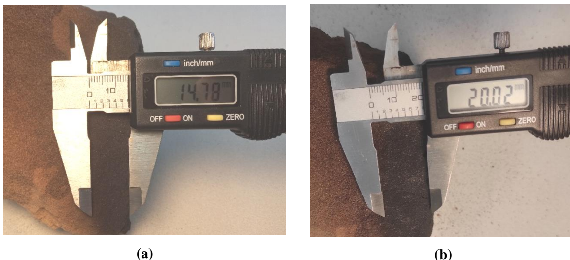
Zdjęcie 7.4. Grubość warstwy przepalanej masy formierskiej zawierającej: (a) MB 2%, (b) MB 5%
