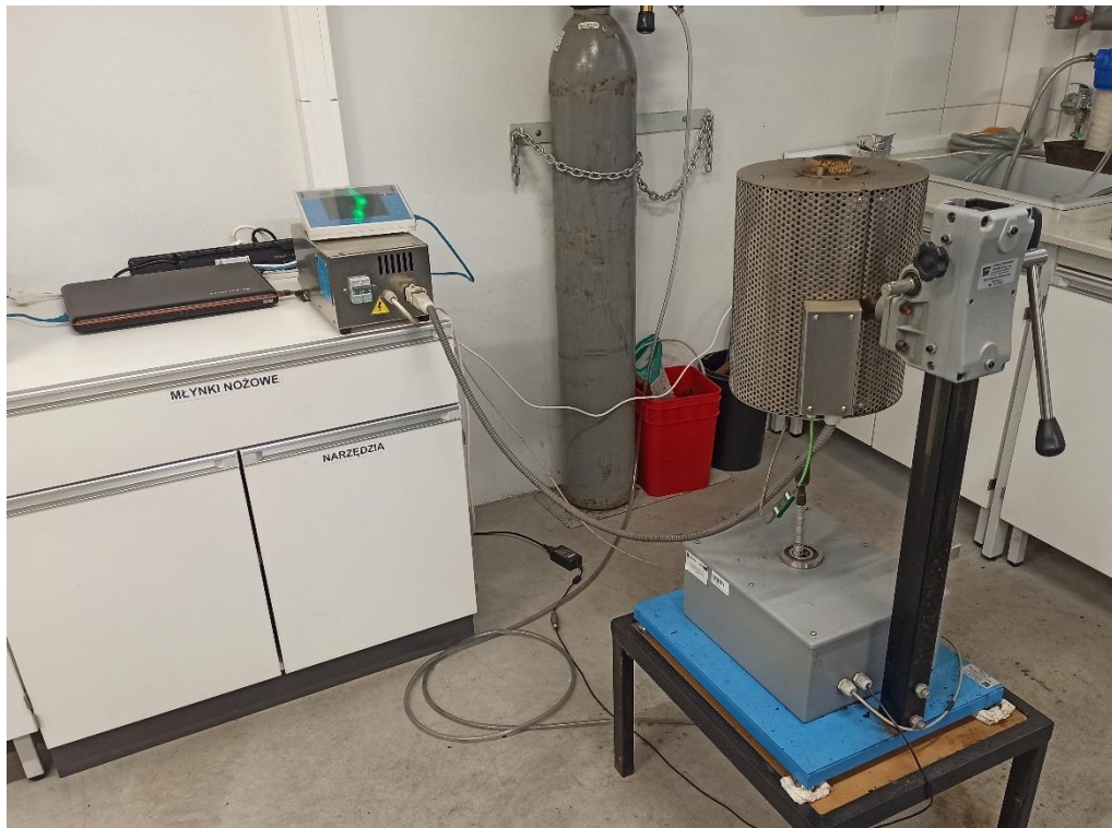
Rysunek 5.5. Aparatura zastosowana do analizy TGA/TG
