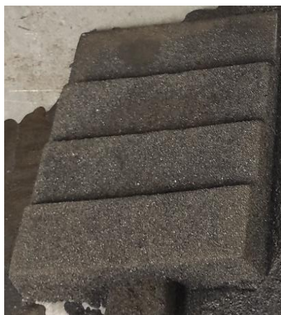
Rysunek 7.3. Odlew wybity z formy z sporządzonej z masy zawierającej MB 2%
