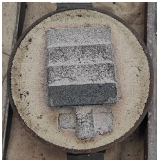
Rysunek 7.2. Otwarta forma po ostudzeniu, wykonana z masy zawierającej MB 2%
