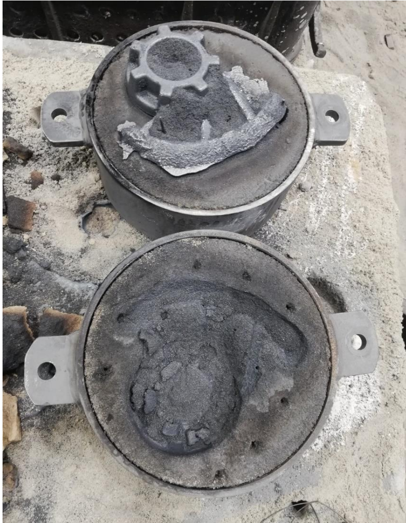
Rysunek 7.20. Widok form odlewniczych po otwarciu przed wybiciem
