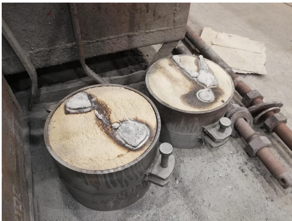
Rysunek 7.19. Widok form odlewniczych po zalaniu
