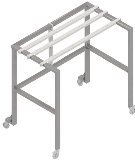
Rysunek 4.8: Konstrukcja do podwieszania badanej struktury
