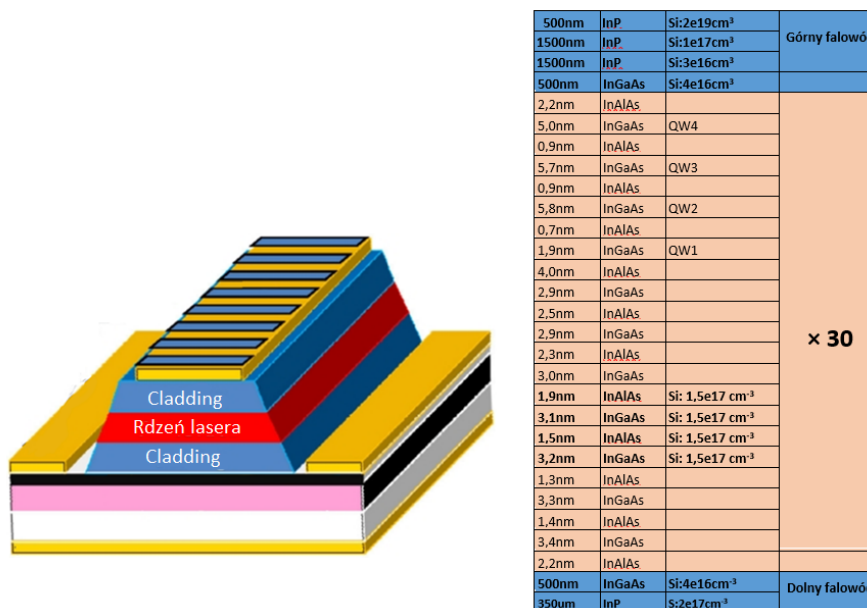
Rys. 1.4. Schemat konstrukcji typowego lasera QCL.
