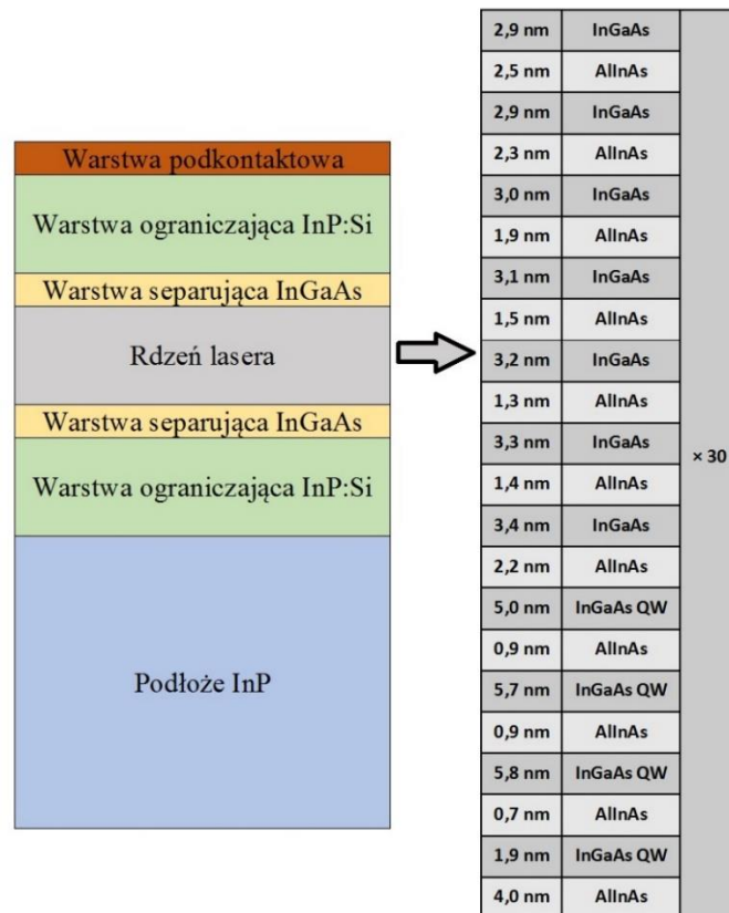
Rys. 3.30. Struktura warstwową oraz schemat rdzenia kwantowego lasera kaskadowego zaprojektowanego na długość fali \lambda = 9 \mu\text{m} [projekt „SENSE”].
