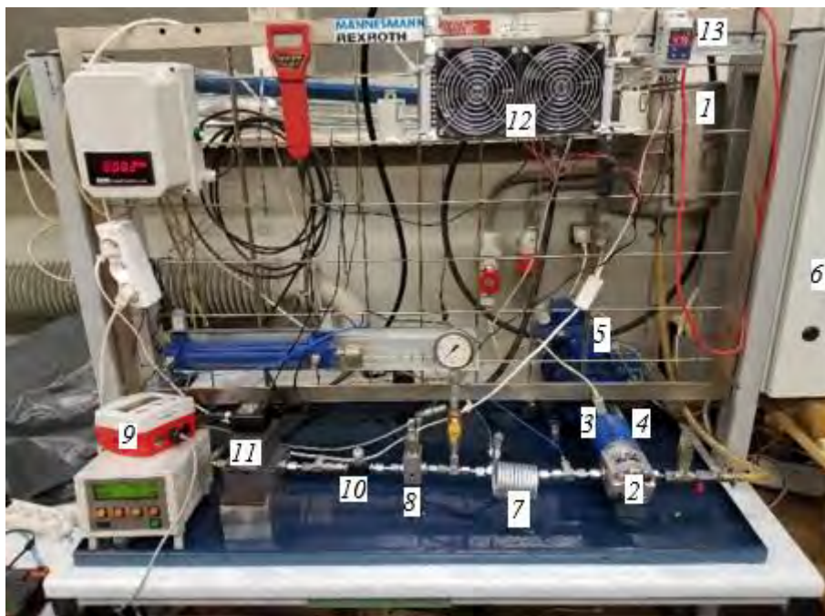
Rys. 122. Widok stanowiska pomiarowego: 1 – zbiornik, 2 – pompa zębata WPH PZ3-0.6, 3 – obrotomierz, 4 – momentomierz MT5Nm-N24, 5 – silnik elektryczny Slh80-B2/PO – 0,75 kW, 6 – szafa sterująca z falownikiem SS-01/07-10/PWR11, 7 - spiralny tłumik pulsacji ciśnienia, 8 – zawór bezpieczeństwa, 9 – przepływomierz, 10 – nastawny zawór dławiący, 11 – przepływomierz, 12 – chłodnica, 13 – termometr.
