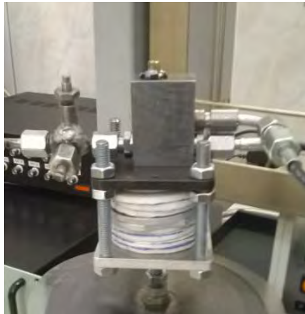
Rys. 96. Uchwyt do redukcji drgań. Po lewej schemat konstrukcyjny: 1 – wzbudnik drgań, 2 - śruba przenosząca drgania, 3 – dolna podstawa uchwytu, 4 – skręcane talerzyki uchwytu, 5 – elementy podatne, 6 – badany mikrozawór. Po prawej widok z przykładowymi wibroizolatorami.
