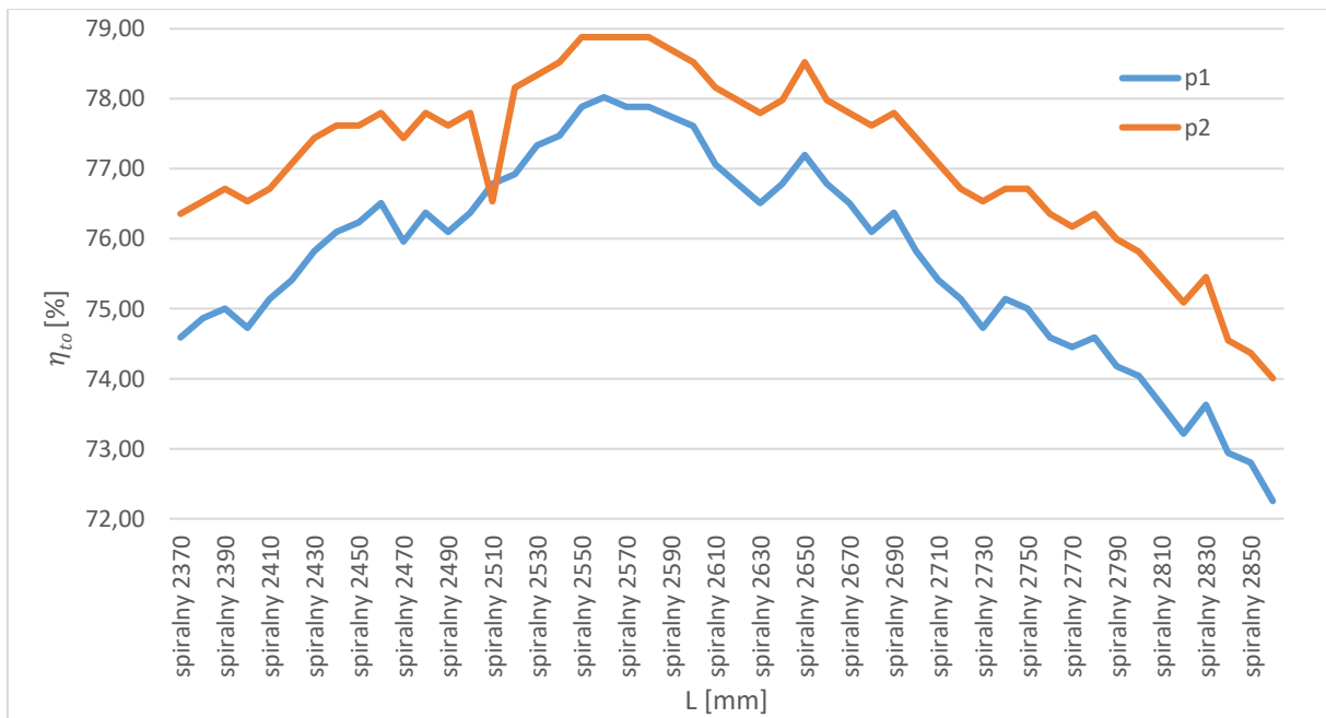
Rys. 163. Porównanie efektywności tłumika spiralnego o różnej długości. Prędkość obrotowej pompy – 800 [obr/min], pierwsza harmoniczna częstotliwość pulsacji pompy – 120 [Hz], ciśnienie średnie 12 [MPa], temperatura cieczy – 30 [°C]
