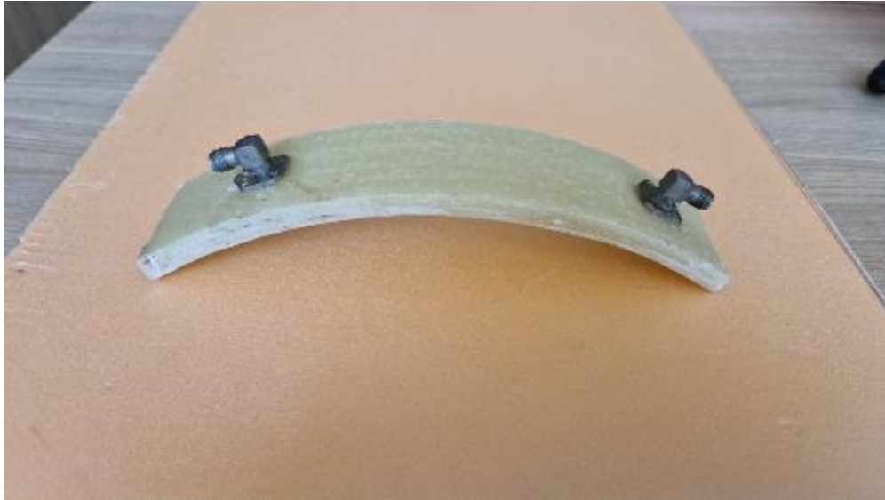
Rys. 7.1.25 a) Przygotowany układ pomiarowy b) Wytworzona próbka ze zintegrowanym czujnikiem.
