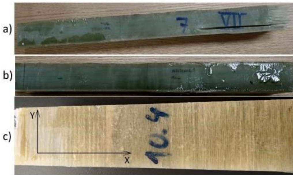
Rys 6.1.2. Przykłady badanych fragmentów rurociągu kompozytowego (a) rozwarstwienie d = 1.0 cm; (b) próbka odniesienia; (c) powierzchnia próbki.
