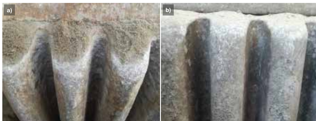
Rys. 2.3. Widok ogólny zębów płyty górnej szczęki stałej: a) 15; b) 29 dnia eksploatacji.
