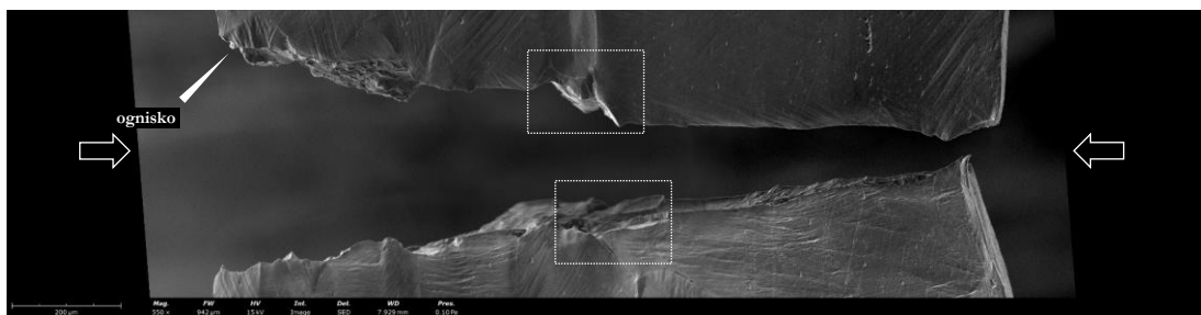
Rys. 5.33. Próbką stali X120Mn12 w stanie dostarczenia bezpośrednio po całkowitym pęknięciu. Ścieżka propagacji pęknięcia w dominującej części ma charakter transkrystaliczny. SEM (SE).
