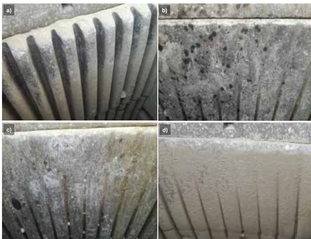
Rys. 2.4. Widok ogólny płyty górnej szczęki stałej: (a) 44; (b) 57; (c) 71; (d) 89 dnia eksploatacji.
