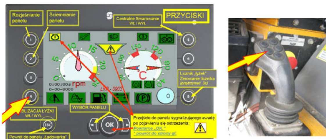
Rysunek 2-7: Kokpit operatora maszyny "cyfrowej" - ładowarka kołowo-przegubowa LKP 1601B, produkcji KGHM ZANAM (źródło: instrukcja DTR)
