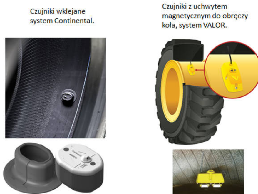
Rysunek 2-13: Czujniki do monitoringu ciśnienia i temperatury opon z transmisją bezprzewodową. (źródło - dokumentacja techniczna KGHM ZANAM)
