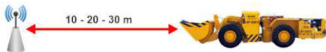
Rysunek 5-34: Idea działania systemu ostrzegającego o ryzyku kolizji. (źródło: instrukcja DTR)
