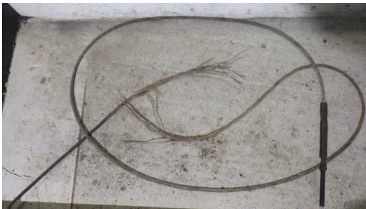
Rysunek 5-10: Zerwana lina powrotu wózka (opracowanie własne)
