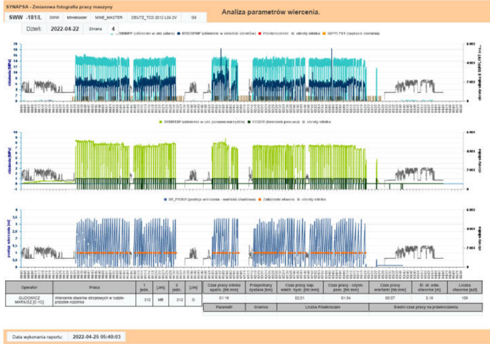
Rysunek 5-12: Raport „Analiza parametrów wiercenia”: przykład nieprawidłowego zarządzania procesem wiercenia - zakleszczenie koronki (opracowanie własne)
