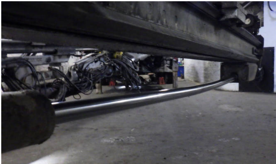
Rysunek 5-9: Wygięty siłownik wysuwu prowadnicy (opracowanie własne)
