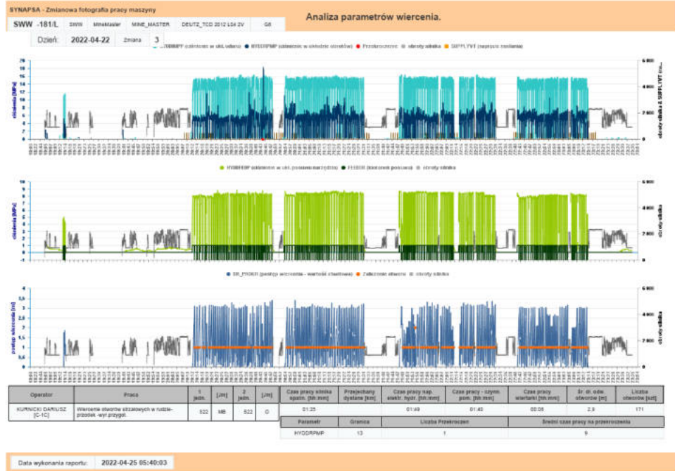
Rysunek 5-13: Raport „Analiza parametrów wiercenia”: przykład nieprawidłowego zarządzania procesem wiercenia - nieprawidłowy poziom ciśnienia posuwu wiertarki (opracowanie własne)
