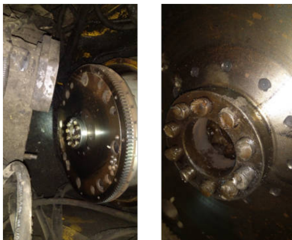
Rysunek 5-62: Uszkodzenie połączenia koła zamachowego z przekładnią hydrokinetyczną (opracowanie własne)
