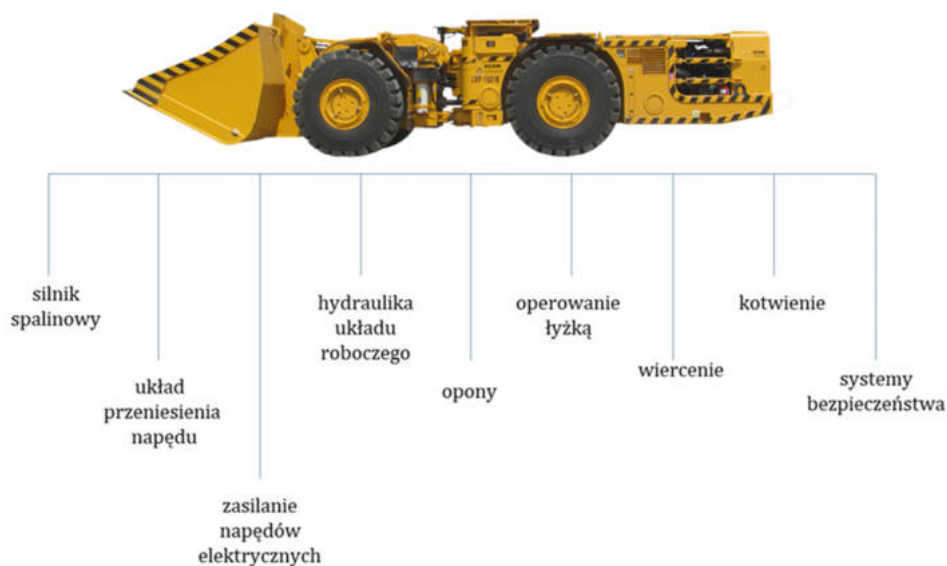
Rysunek 5-47: Dekompozycja maszyny SMG na najważniejsze podukłady (opracowanie własne)
