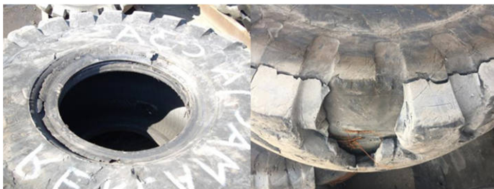
Rysunek 2-12: Przykład uszkodzenia opony na skutek przegrzania - rozwarstwienie (opracowanie własne)
