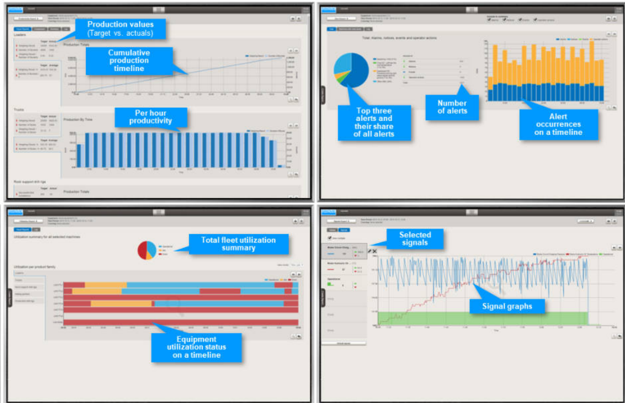
Rysunek 2-3: Raporty: produktywność, wykorzystanie maszyn, alerty, wykresy dla wybranych surowych sygnałów (źródło: prezentacja firmy Sandvik)
