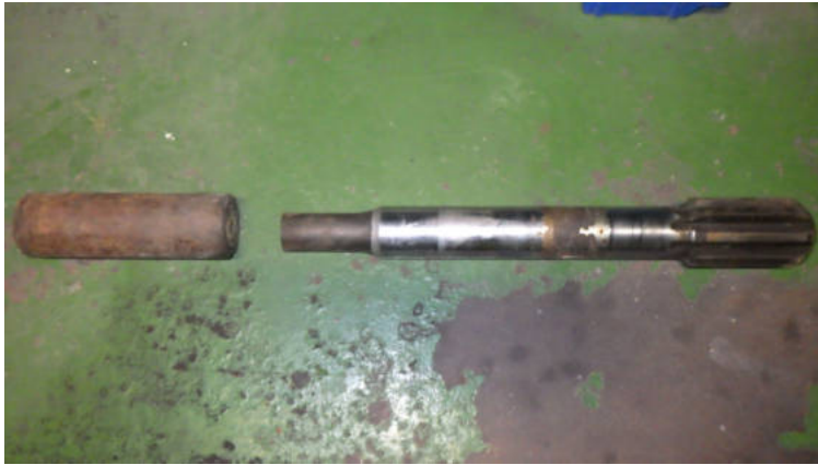
Rysunek 5-8: Zerwany łącznik wiertarki hydraulicznej (opracowanie własne)
