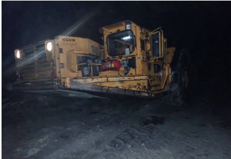
Rysunek 4-6: WO CB4 20TB - transport urobku po upadowej (opracowanie własne)
