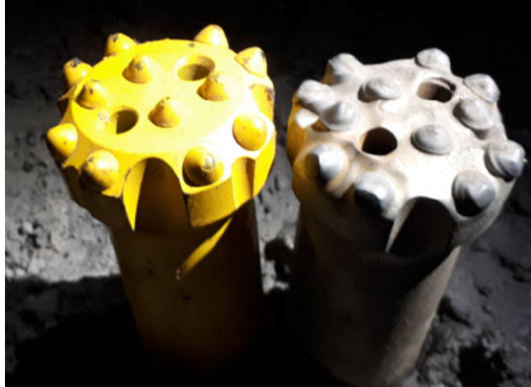
Rysunek 4-14: Koronki wiertnicze: nowa oraz zużyta w stopniu pozwalającym na regenerację (opracowanie własne)
