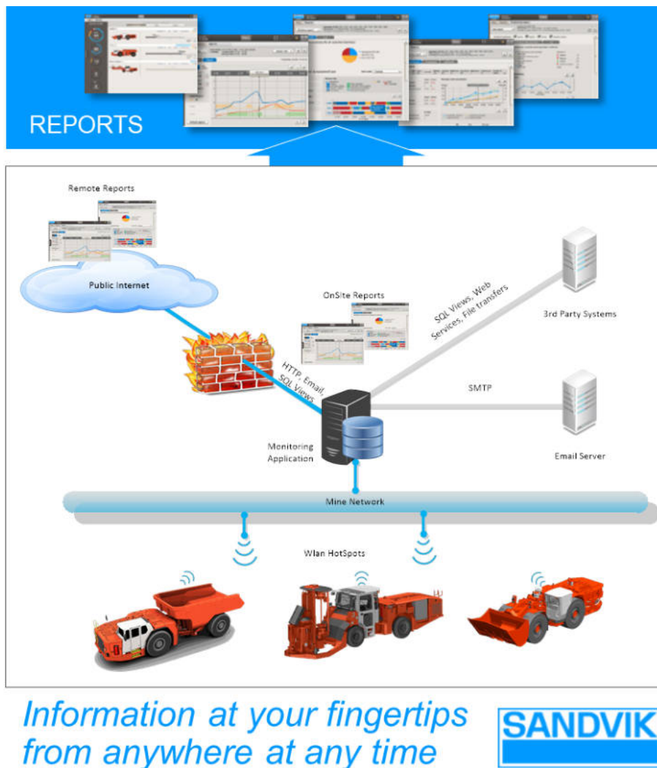
Rysunek 2-2: Optimine - schemat poglądowy monitoringu maszyn (źródło: prezentacja firmy Sandvik)
