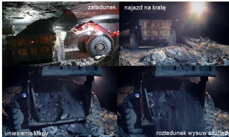
Rysunek 4-7: Eksperyment dołowy - załadunek na przodku oraz rozładunek wozu odstawczego na kratce (opracowanie własne)
