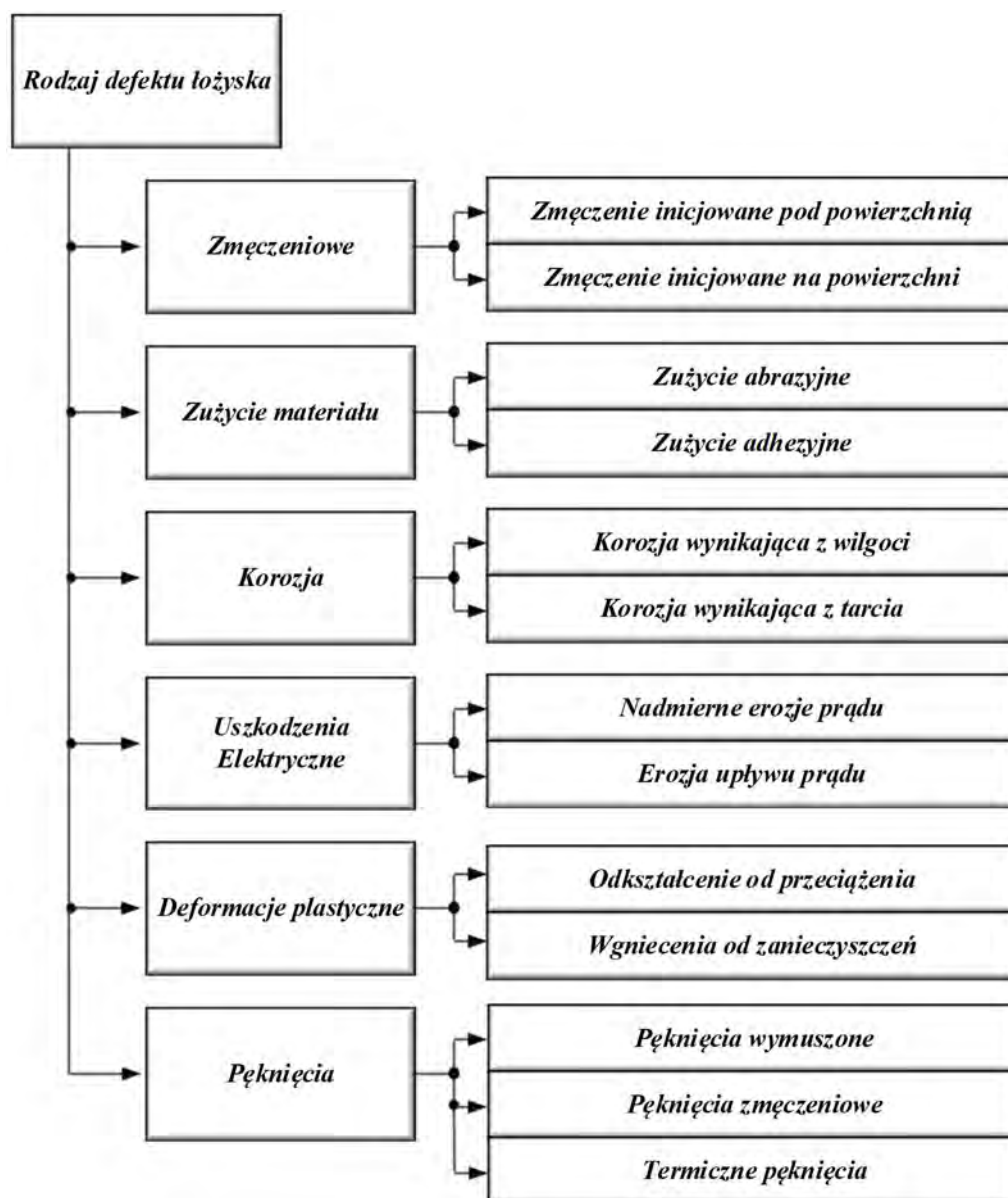
Rys. 4.5 Klasyfikacja uszkodzeń łożysk tocznych.
