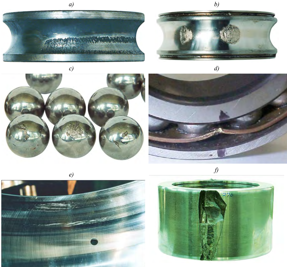
Rys. 4.6 Uszkodzenia łożysk tocznych [81], [109].
