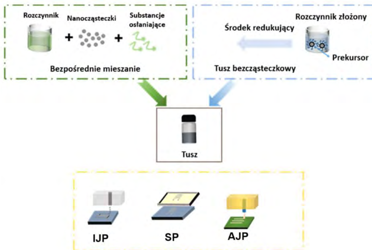
Rys. 43. Sposoby przygotowania tuszy oraz techniki drukowania [142]
