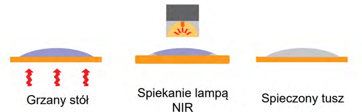
Rys. 127. Schemat postępowania w przypadku spiekania tuszu 6n
