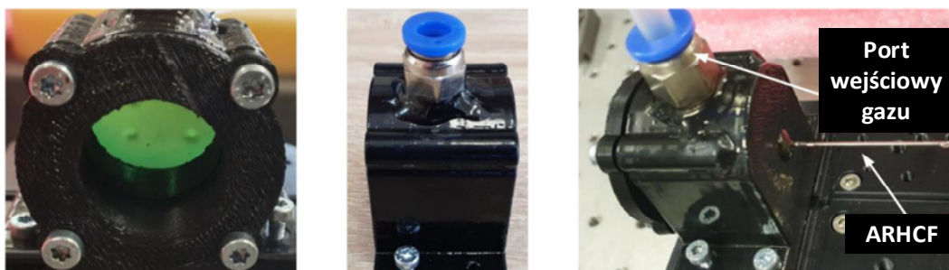
Rysunek 65. Komórka gazowa umożliwiająca napełnienie ARHCF mieszkanką pomiarową [208]. Była to pierwsza z opracowanych wersji komórki gazowej wykonana na drukarce 3D.
