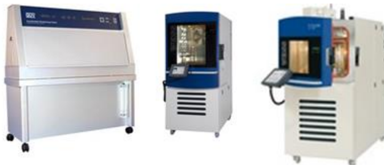
Rysunek 29. Zdjęcia komór przyspieszonego starzenia: od lewej komora UV, komora klimatyczna, komora szoków termicznych.
