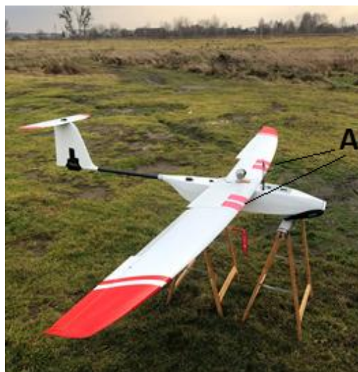
Rysunek 34. Dron użyty do testów polowych podczas przygotowań do startu. Literą A oznaczono fragmenty skrzydeł z naniesionymi powłokami w postaci piaskowanych kompozytów żywicy EPHL modyfikowanej OXI i 4DIOL.
