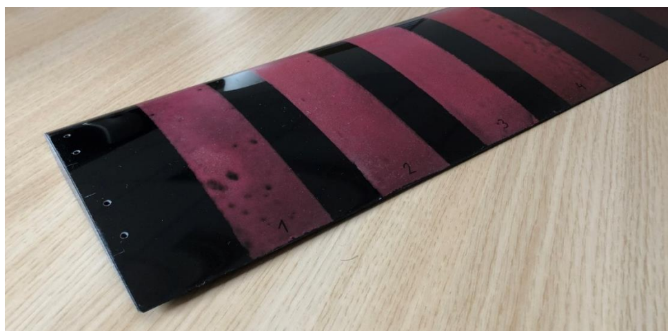
Rysunek 33. Fragment skrzydła wykorzystany do badań w tunelu aerodynamicznym. Próbki w postaci powłok wykonanych z kompozytów żywicy oraz próbka referencyjna są numerowane i mają kolor czerwony.
