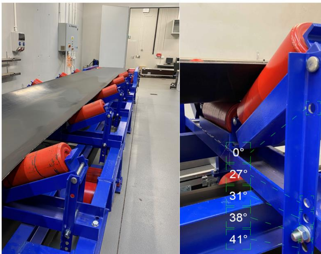
Rysunek 34. Konstrukcja przenośnika umożliwiające dostosowanie kąta niecki na potrzeby zmiany sztywności zginania przekroju porzecznego taśmy (fotografia własna).
