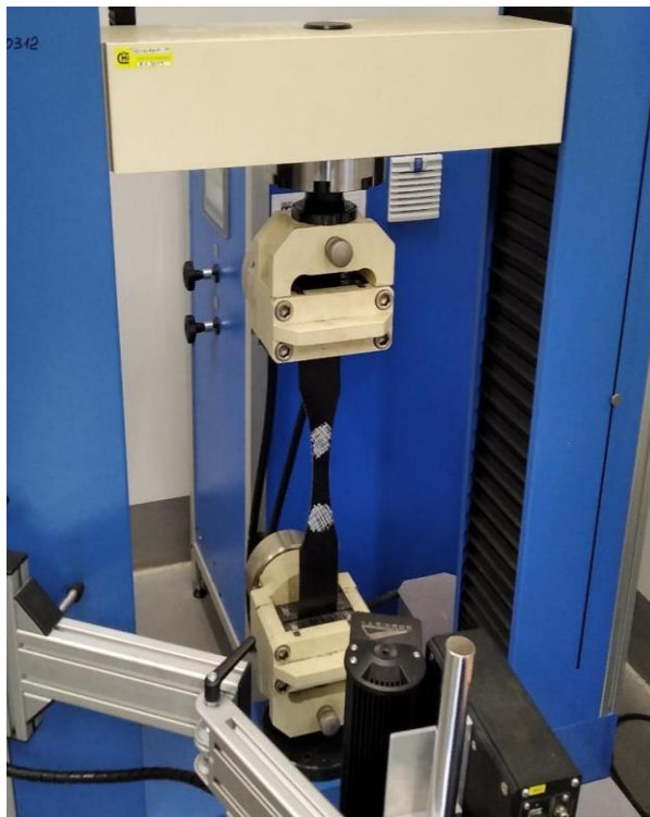
Rysunek 35. Pomiar modułu statycznego próbki taśmy przenośnikowej w warunkach laboratoryjnych (fotografia własna).
