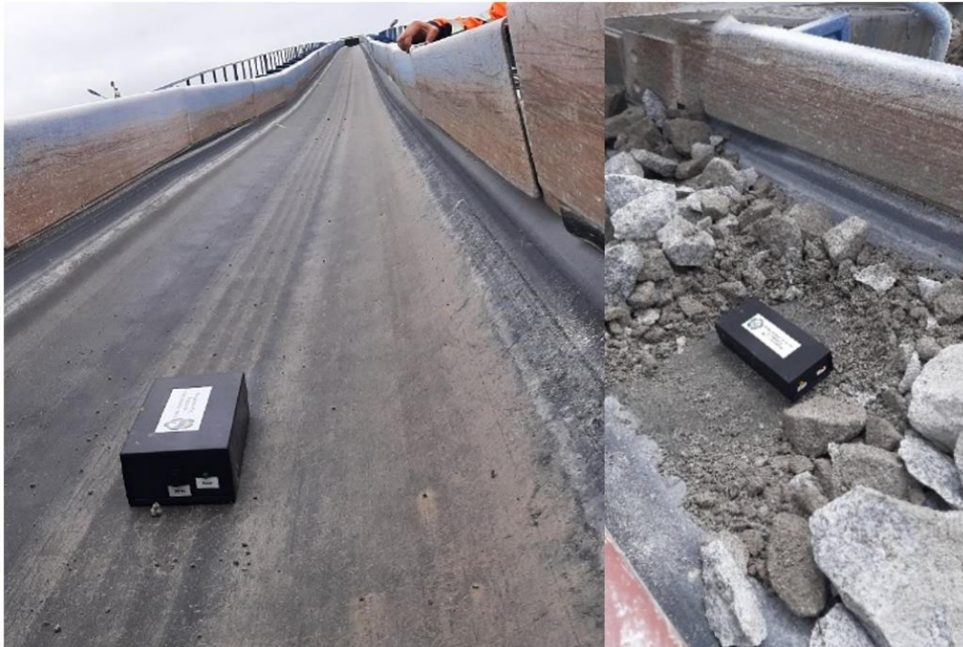
Rysunek 54. Urządzenie pomiarowe zlokalizowane na ruchomej taśmie przenośnika (zdjęcie własne).
