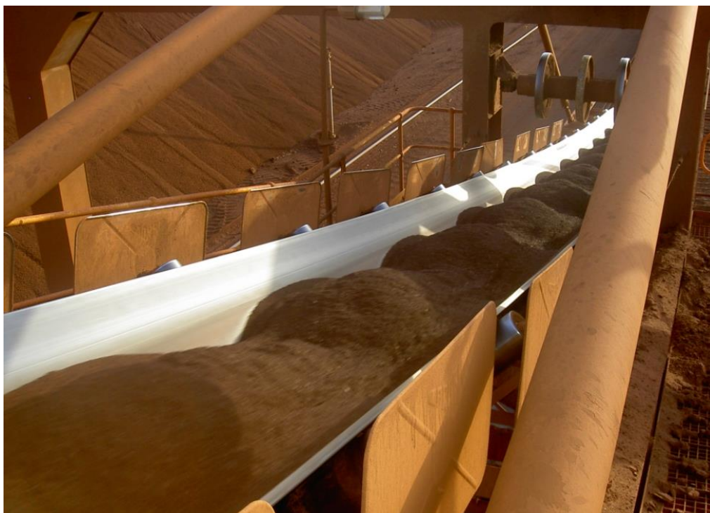
Rysunek 4. Charakterystyczne, formowane cyklicznie „kopce” transportowanego materiału, wywołane wystąpieniem rezonansu (Helix Technologies Pty Ltd).
