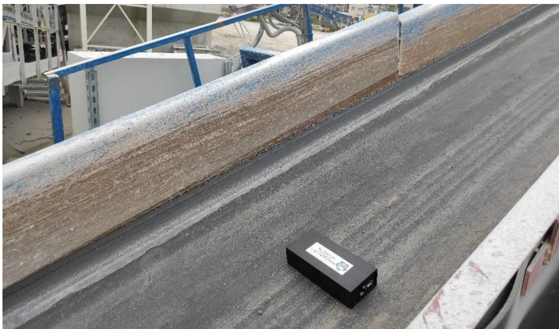
Rysunek 19. Układ pomiarowy, składający się z rejestratora przytwierdzonego do taśmy przemieszczającej się na taśmie przenośnika w kopalni surowców skalnych (fotografia własna).
