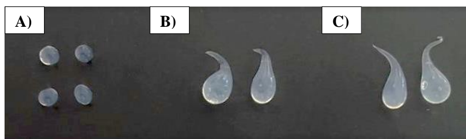
Rysunek 16. Hydrożele na bazie 2% (m/m) roztworu ALG1 (A), ALG2 (B) i ALG3 (C)
