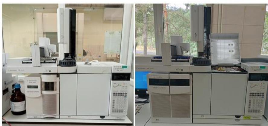
Rysunek 107. Chromatograf gazowy sprzężony z detektorem masowym GC/MS ( po lewej), chromatograf gazowy sprzężony z detektorem masowym GC/MS/MS (po prawej)
