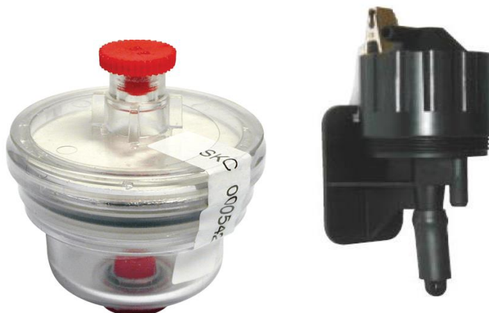
Rysunek 6. Po lewej kaseta SKC DPM do pobierania próbek na oznaczenie węgla elementarnego w powietrzu. Po prawej przedstawiono przykładowy próbnik, w którym umieszcza się kasetę SKC DPM oraz podłącza aspirator ustawiając prawidłowy przepływ w danym miejscu pobierania próbek
