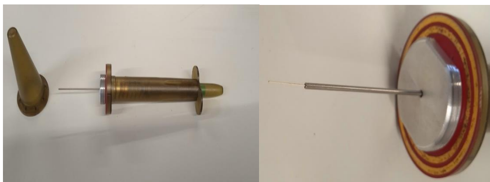
Rysunek 102. Po lewej i prawej stronie przedstawiono włókno SPME CUSTODION firmy Perkin Elmer, które służy do pobierania próbek na oznaczanie LZO z powietrza metodą pasywną/dyfuzyjną
