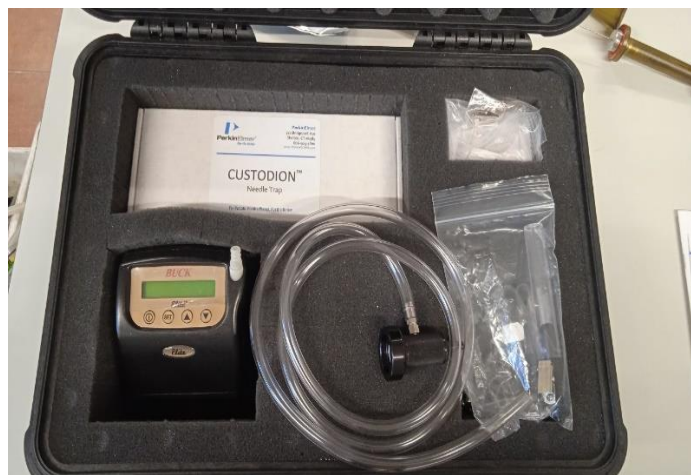
Rysunek 103. Przykładowy zestaw składający się z aspiratora, rurek, wężyków oraz innych akcesoriów umożliwiających pobieranie próbek na oznaczanie LZO w powietrzu metodą aspiracyjną za pomocą włókna SPME CUSTODION firmy Perkin Elmer
