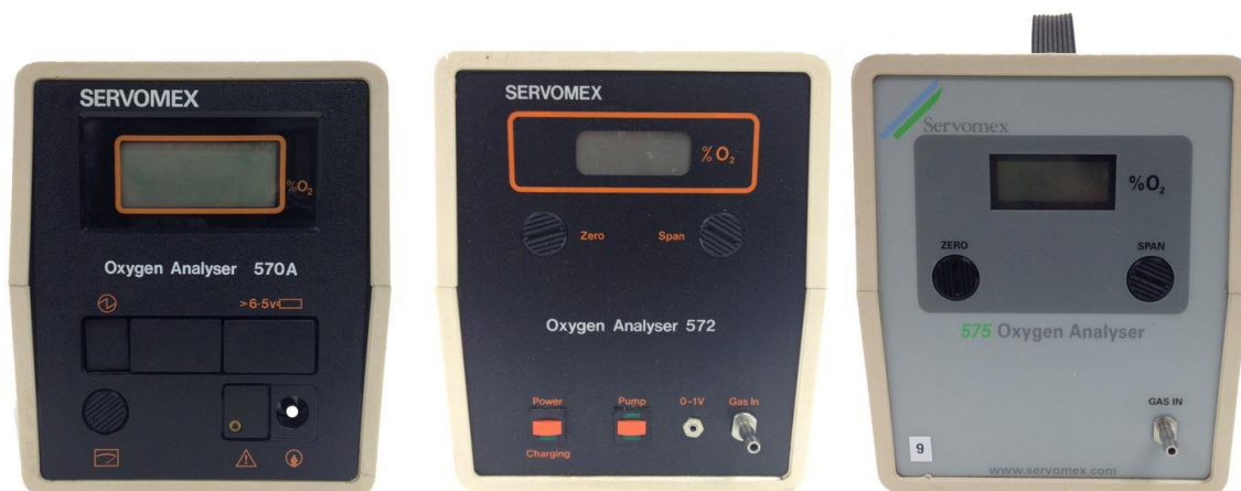
Rysunek 14. Przykładowe urządzenia wyposażone w czujnik paramagnetyczny do pomiaru tlenu i azotu w próbkach gazów środowiskowych. Źródło: https://applied-inc.com/are-you-calibrated (06.2023)
