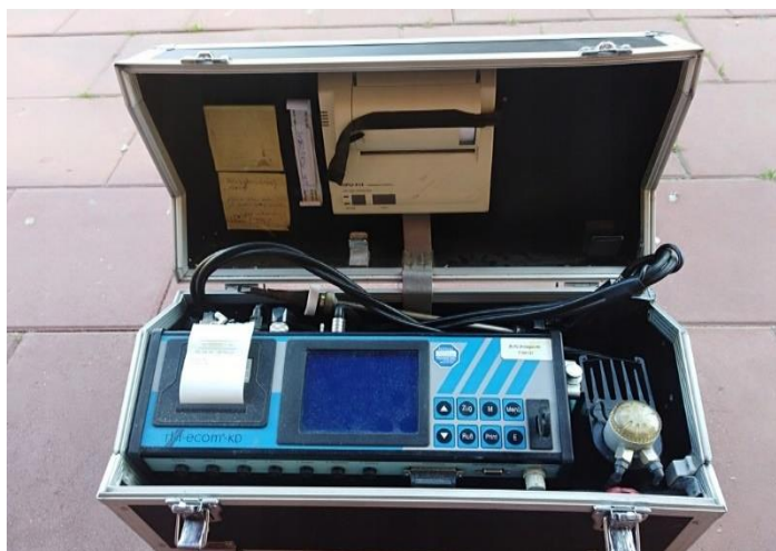
Rysunek 12. Przykładowy miernik wielogazowy wyposażony m.in. w czujniki elektrochemiczne formy Drager (po lewej) oraz analizator spalin firmy Ecom, w którym do pomiarów różnych parametrów wykorzystywane są czujniki elektrochemiczne ( po prawej). Źródło: drager.com, ecom.com (06.2023)
