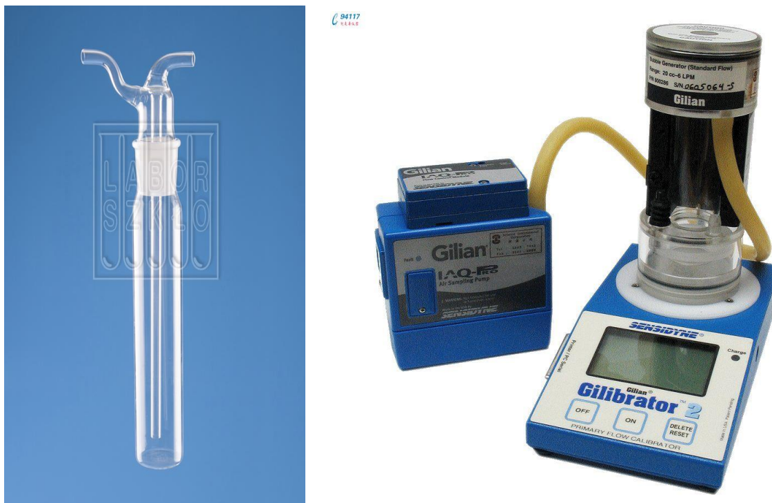
Rysunek 19. Płuczka szklana bełkotkowa służąca do pobierania próbek gazów (po lewej) i aspirator firmy Gilian (po prawej). Źródło: sensidyne.com (06.2023)
