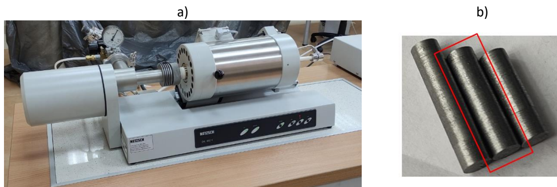
Rys. 56 Badanie rozszerzalności cieplnej: a) dylatometr NETZSCH DIL 402C, b) próbki do badań wycięte z materiału docelowego
