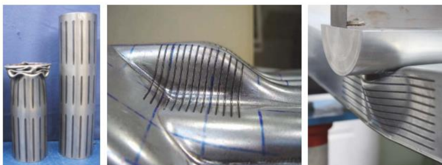
Rys. 10 Przykłady aplikacji technologii przetapiania laserowego dla stalowych elementów cienkościennych [33]
