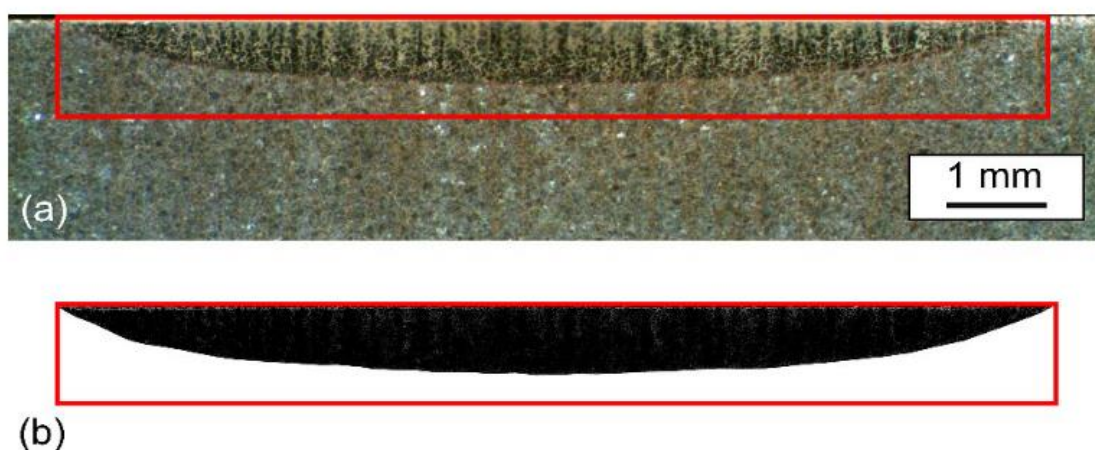
Rys. 30 Przekrój poprzeczny obszaru zahartowanego w postaci zglądu metalograficznego: (a) obraz z mikroskopu optycznego z prostokątnym zaznaczeniem ocenianego obszaru oraz (b) kształt obszaru zahartowanego z obrazu (a) [99]
