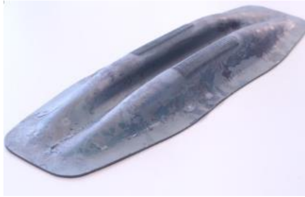
Rys. 12 Element hartowany w prasie z dodatkowymi wzmocnieniami wytworzonymi technologią napawania laserowego [41]
