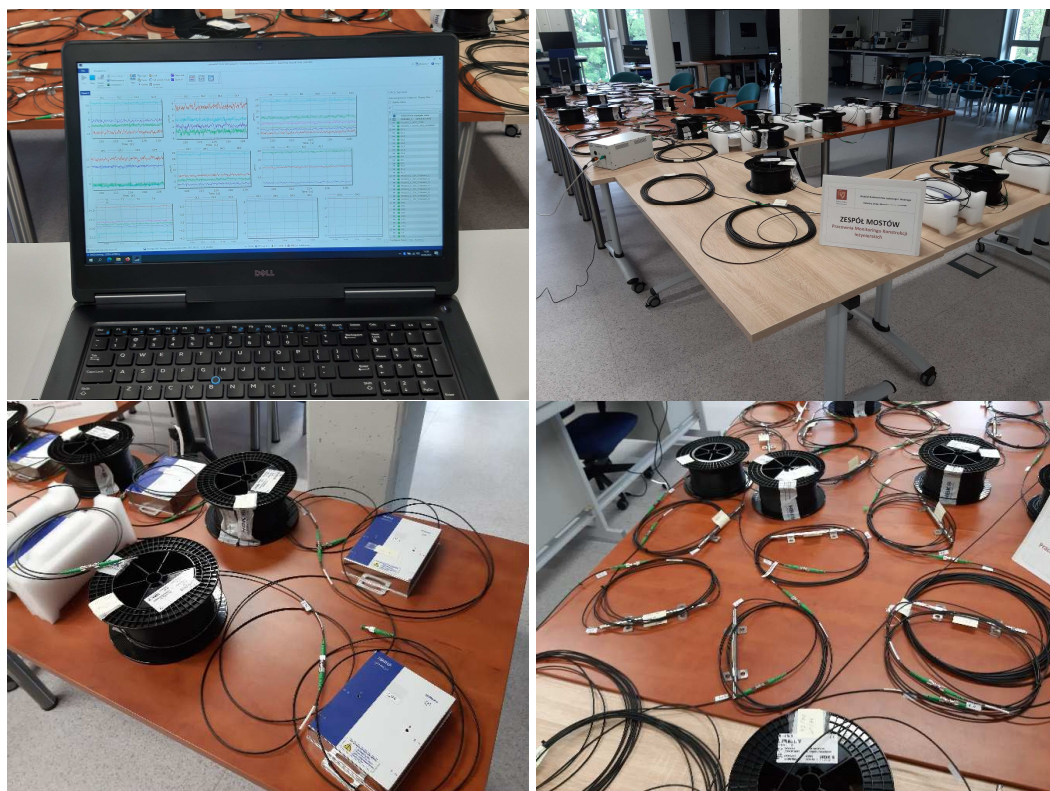
Rys. 14. Próbny montaż i testowanie docelowego układu pomiarowego w warunkach laboratoryjnych – widok wybranych elementów układu pomiarowego
