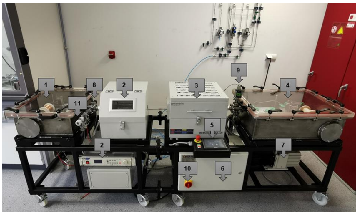
Rys. 22. Wdrożony system do ciągłej syntezy grafenu: 1 – komora próżniowa ze szpulą nadawczą, 2 – system RF, 3 – piec rurowy, 4 – komora próżniowa ze szpulą odbiorczą, 5 – panel operatorski, 6 – szafa sterownicza, 7 – pompa próżniowa, 8 – czujnik ciśnienia (bezpieczeństwa), 9 – czujnik próżni (precyzyjny), 10 – włącznik główny, 11 – zawór próżniowy dozujący ciekłe węglowodory.
