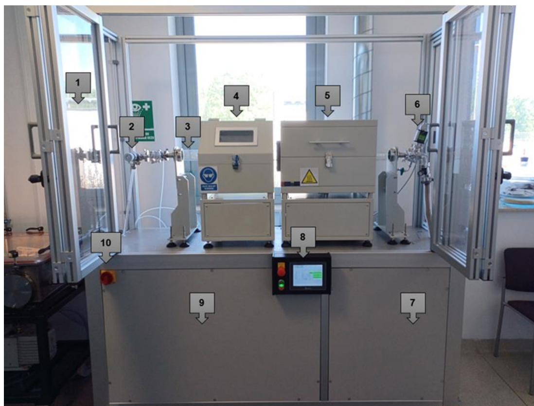
Rys. 23. Wdrożony system do okresowej syntezy grafenu: 1 – obudowa stanowiska, 2 – zawór dozujący ciekłe węglowodory, 3 – rura kwarcowa (komora reakcyjna), 4 – moduł impedancji i antena RF, 5 – piec rurowy (strefa grzejna), 6 – czujnik próżni, 7 – pompa próżniowa (zabudowana w dźwiękoszczelnej obudowie), 8 – panel operatorski, 9 – generator plazmy RF oraz układ podawania gazów zabudowany w obudowie, 10 – włącznik główny.
